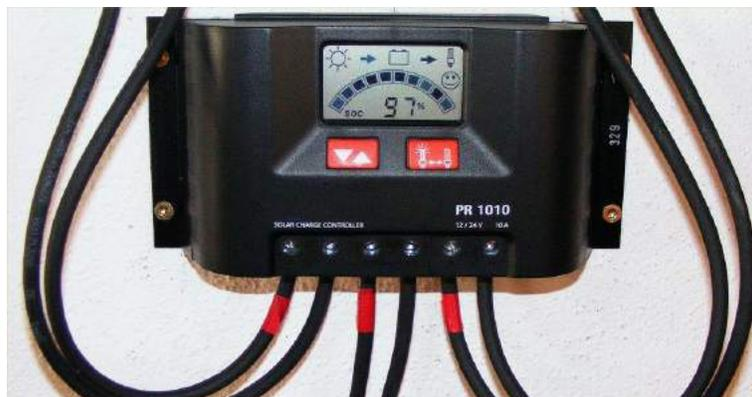
El regulador dispone de tres pares de conexiones (terminales), a los que se deberá conectar la batería, el módulo y los equipos de consumo. Es MUY IMPORTANTE observar el siguiente orden de conexionado. Respételo siempre para evitar posibles daños al regulador y a los equipos conectados a su salida:
