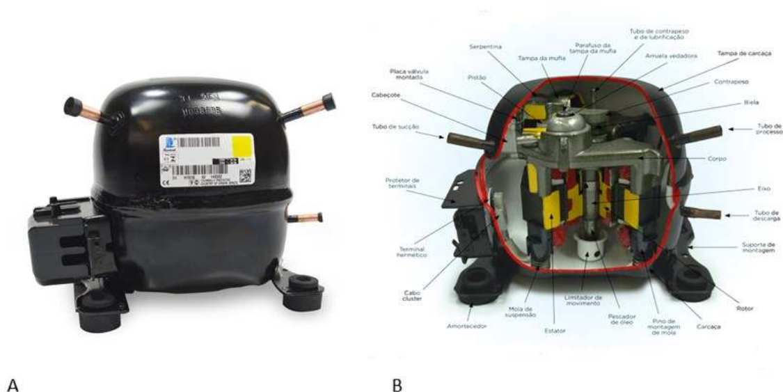
Figura 62 – Compressores alternativo recíproco hermético (A) visão externa; (B) visão interna
