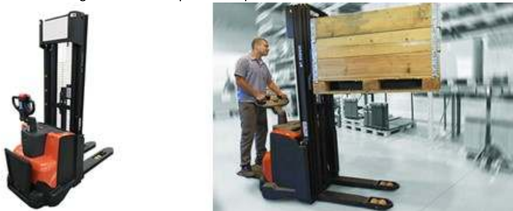
Figura 107 – Exemplos de empilhadeira elétrica
