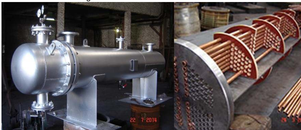
Figura 58 – Trocador de calor casco e tubo
