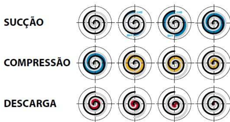
Figura 73 – Processo de compressão scroll
