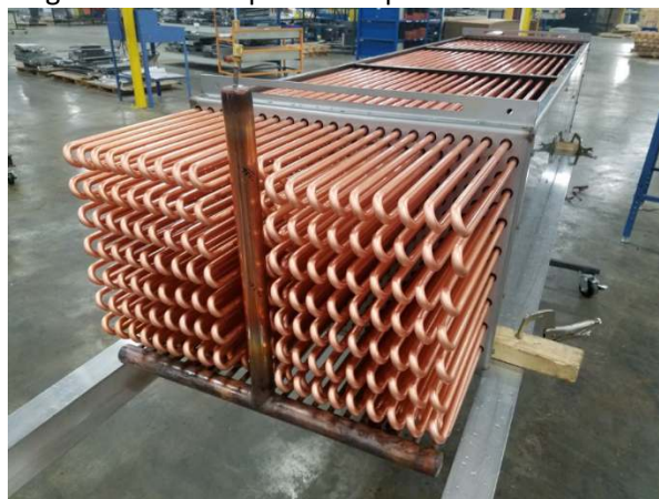
Figura 41 – Exemplo de evaporador de tubo liso
