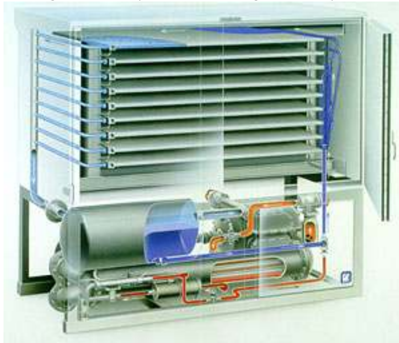
Figura 11 - Exemplo de túnel de congelamento a placas
