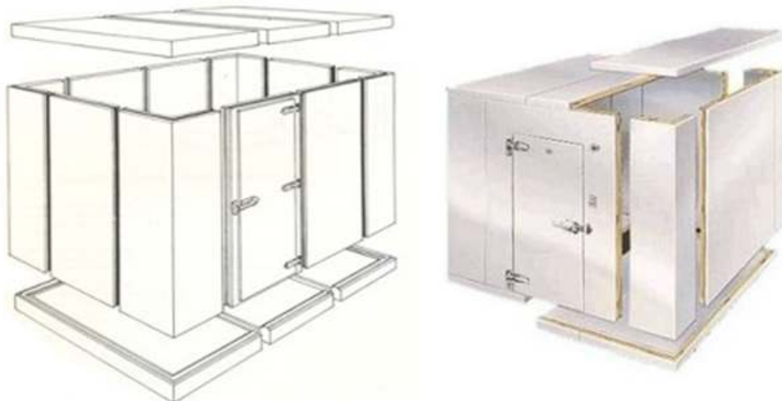
Figura 40 – Estrutura e montagem de câmara fria modular utilizando painéis pré-fabricados
