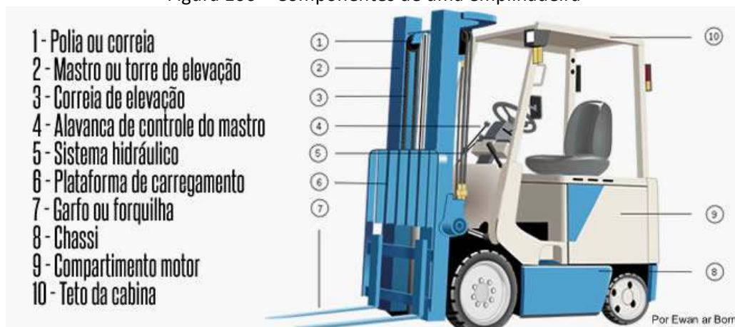
Figura 106 – Componentes de uma empilhadeira
