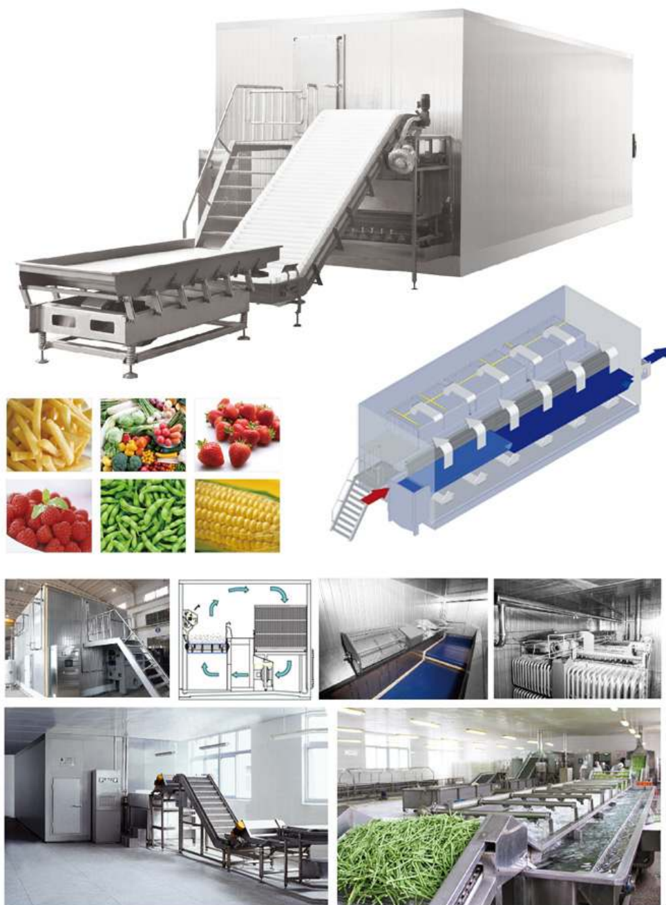
Figura 13 - Esquema de um congelador de leito fluidizado
