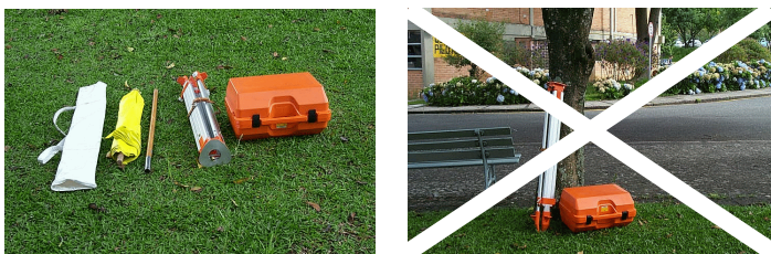
Figura 6.29 - Disposição dos equipamentos enquanto não utilizados.
