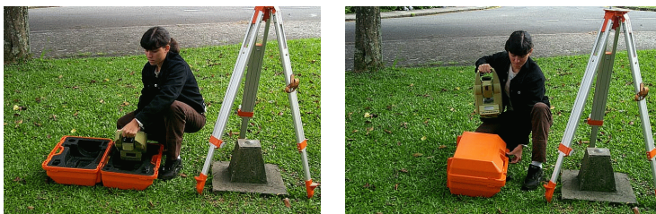
Figura 6.33 - Retirando o instrumento da caixa.
