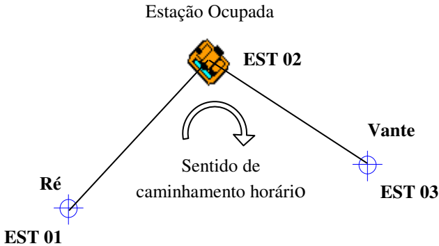
Figura 9.14 - Estação ré e vante.
