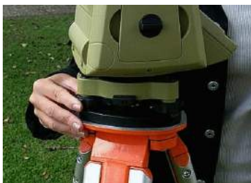
Figura 6.43 - Centragem da bolha atuando no parafuso ortogonal a linha inicial.
