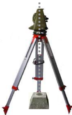
Figura 6.35 - Eixo principal do equipamento passando pelo ponto.
