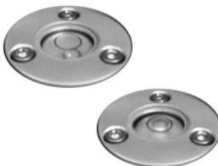
Figura 6.39 - Calagem da bolha do nível esférico.
