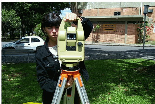
Figura 6.34 - Fixando o equipamento ao tripé.
