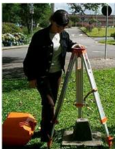
Figura 6.31 - Cravando o tripé no solo.
