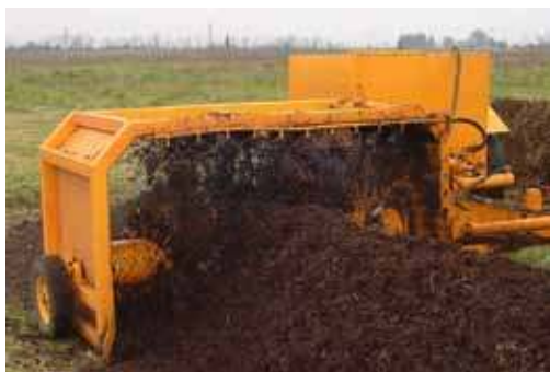
Figura 6. Máquina volteadora de compost con sistema de riego incorporado.
