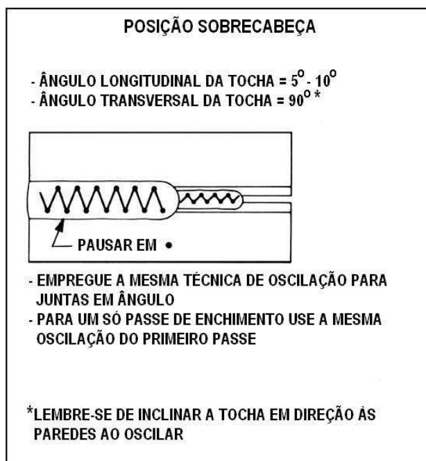
Figura 38 - Manipulações da tocha na posição sobrecabeça
