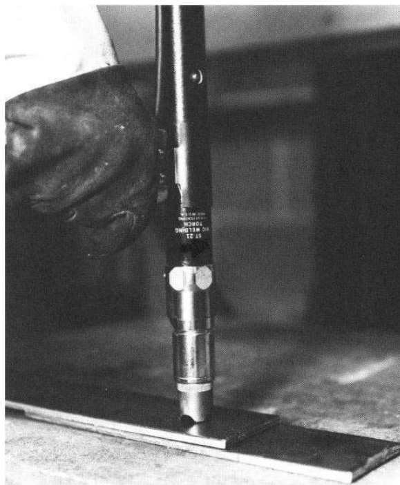
Figura 60 - Técnica de execução de uma solda pontual
