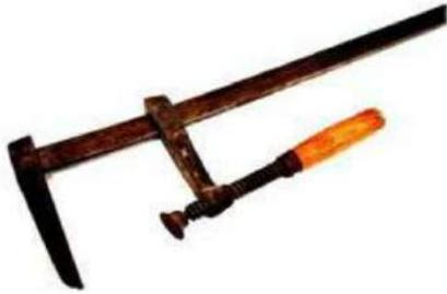
**Gato:** Instrumento de hierro que sirve para agarrar fuertemente la madera y traerla a donde se pretende. Se usa para echar aros a las cubas, y en el oficio de portaventanero. Máquina compuesta de un engranaje de piñón y cremallera, con un trinquete de seguridad, que sirve para levantar grandes pesos a poca altura. También se hace con una tuerca y un husillo. Implemento que se usa en construcción, en los trabajos de
