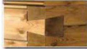
**Cola de milano cubierta:** Ensambladura de ángulo entre dos piezas en la cual sólo se muestra la fibra por el extremo de una de ellas, dejando un espesor suficiente de madera en ella al tallar la junta, para que se cubra la fibra del extremo de la otra. También se llama "ensambladura de frente de cajones".
