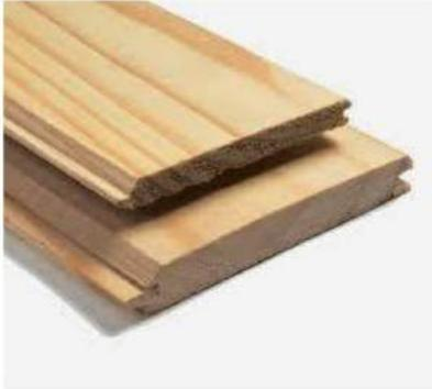
**Machihembrado:** Ensamble de tablas por sus cantos, de manera que la lengüeta de una de ellas encaja en la ranura de la otra. También se conoce como ensamble a ranura y lengüeta. Es sin dudas la forma más utilizada para unir tablas o tabloncillos de canto. Generalmente se fabrica estandarizado en aserraderos.
