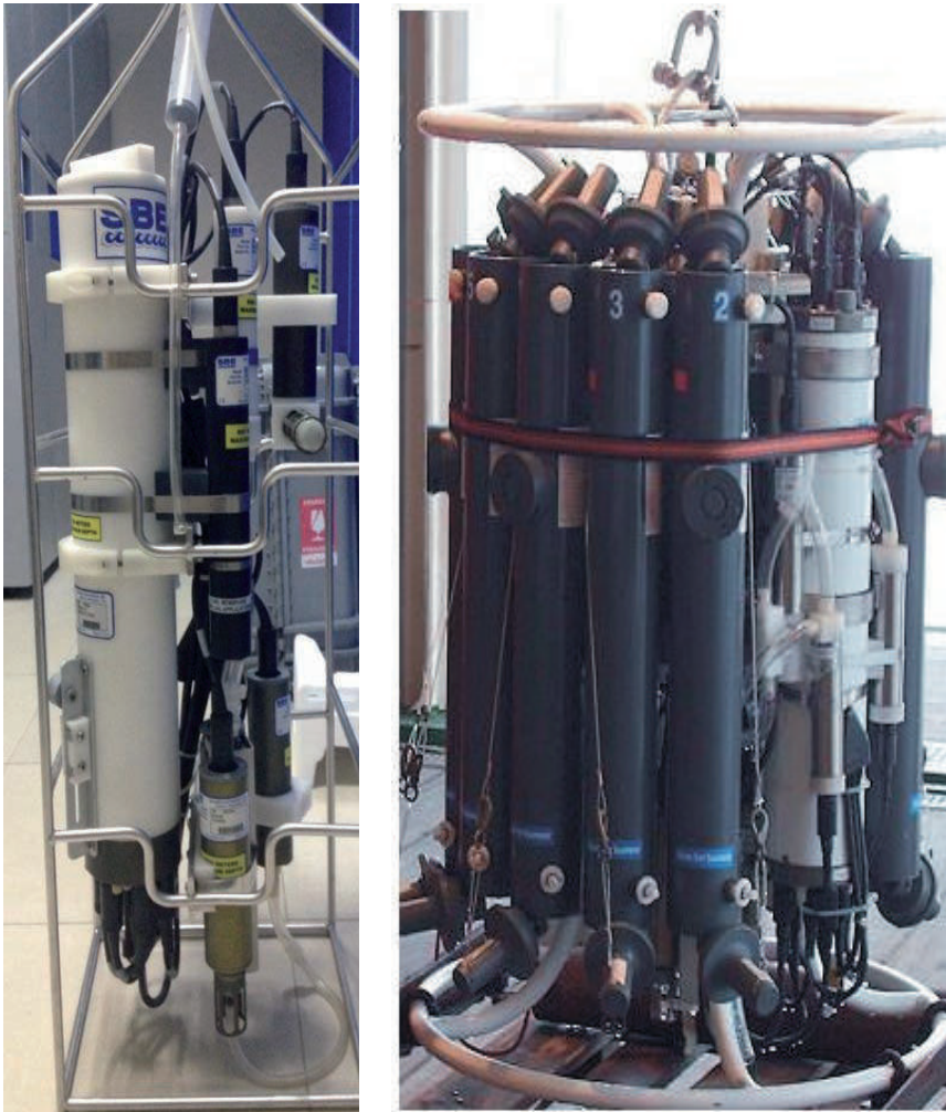
Figura 7.10 Izquierda. Perfilador de conductividad, temperatura y profundidad - CTD, Sea Bird 25. Fuente: Cortesía Capitán de Corbeta Leonardo Marriaga Rocha, CIOH. Derecha. CTD (sensor blanco) con botellas Niskin (PVC gris) instaladas en una roseta muestreadora. Fuente: Cortesía Ph.D Andrea Devis Morales.
