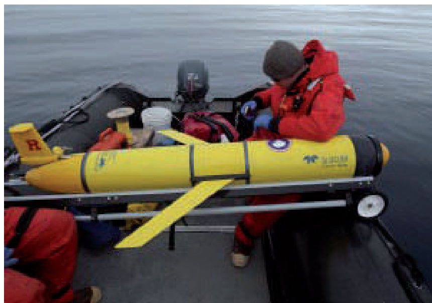
Figura 7.9. AUV tipo Slocum. Laboratorio de Observación Oceánico Costera de la Universidad de Rutgers de los Estados Unidos de América. Fuente: Antarctic Research.
