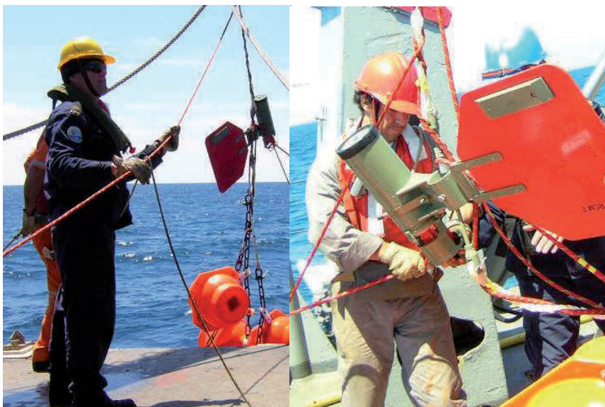
Figura 7.1. Instalación de un correntómetro mecánico.
