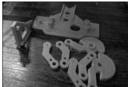
Figura 5. Componentes impresos en Prusa-i3®
