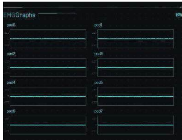
Figura 29. Señales obtenidas por el sensor con la mano abierta.
