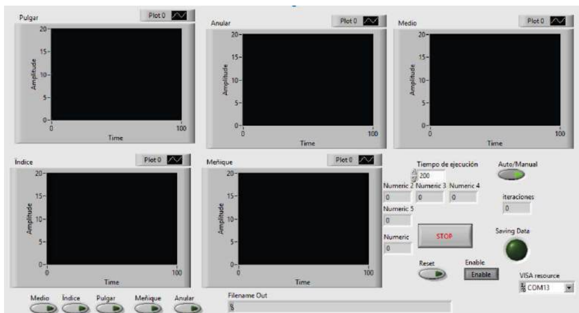
Figura 5. Interfaz de usuario para control y monitoreo del sistema de medición de fuerza.
