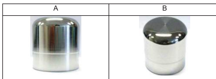
Figura 6. (A) Vista lateral y (B) frontal de punzón de 6.2 cm de alto, 5 cm de diámetro.
