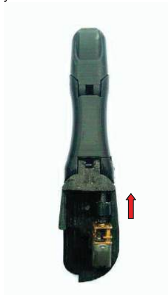
Figura 15. Posicionamiento del actuador dentro de la estructura del metacarpo del dedo pulgar robótico
