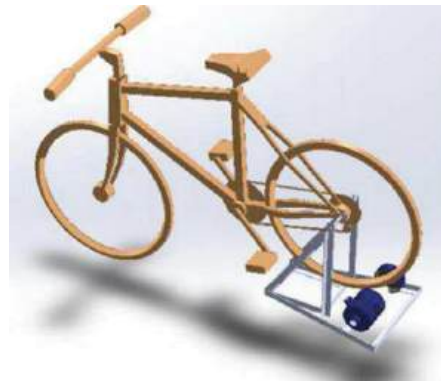
Figura 8. Modelo de la bicibomba con montaje de la bicicleta.
