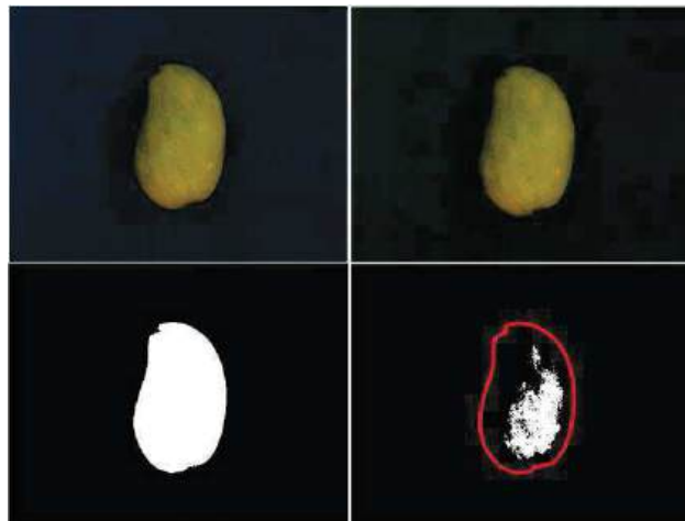
Figura 12. Mango Ataulfo que se considero verde. Se muestran sus 4 etapas de procesamiento y su resultado fue por debajo de la cota inferior establecida.
