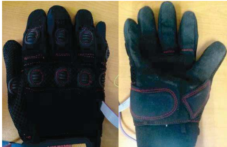
Figura 3. Guante con los sensores FSR402.
