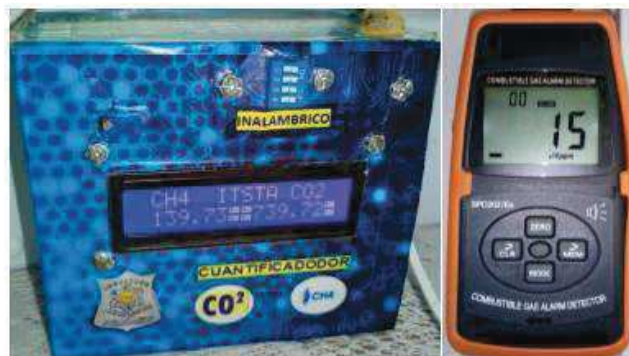
Figura 6. Calibración del sensor MQ-4
