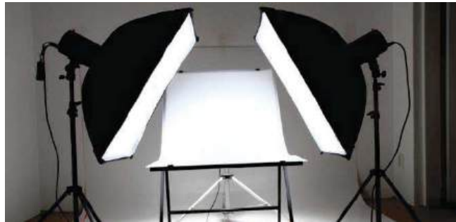
Figura 1. Ejemplo de iluminación difusa. (Kirkman, 2016)
