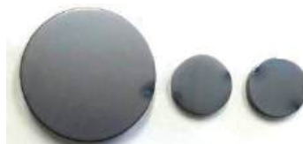
Figura 11. Sustratos de acero M2 de dos tamaños diferentes con recubrimiento de c-AlTiN.
