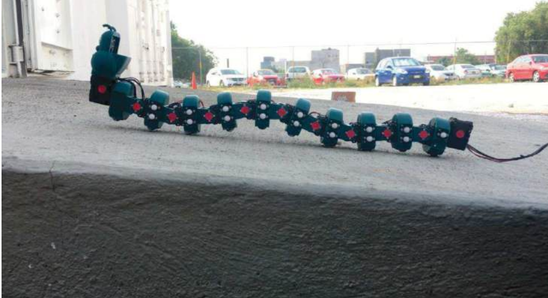
Figura 18. Robot gusano desplazándose en una superficie inclinada de concreto.
