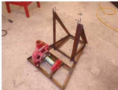
Figura 11. Base de la bicibomba terminada
