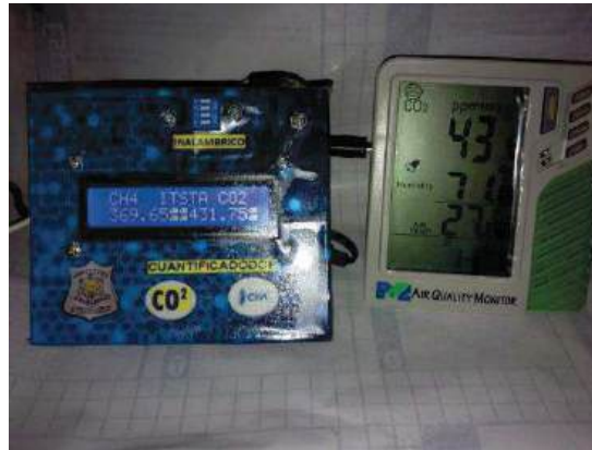
Figura 7. Calibración del sensor MQ-7
