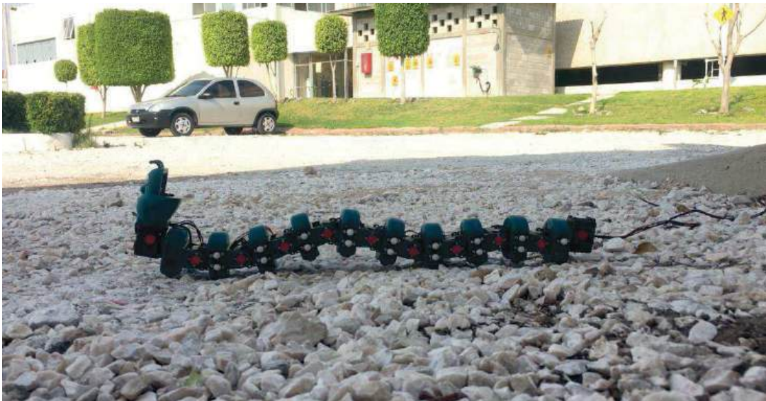
Figura 19. Robot gusano desplazándose en una superficie rocosa.
