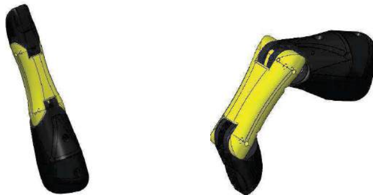
Figura 13. Isométrico solido del dedo pulgar robótico multiarticulado antropométrica y antropomórfico
