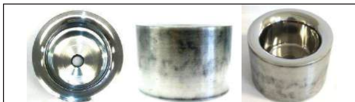
Figura 5. Matriz de 6.2 cm de alto y 9.2 cm de diámetro exterior.
