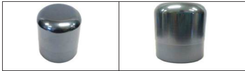
Figura 12. Punzón de acero D2 con recubrimiento de c-AlCrN.
