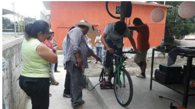
Figura 15. Pruebas de bombeo con el dispositivo.
