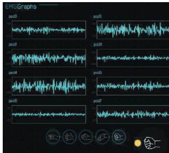
Figura 32. Señales tomadas del puño e indicadores mostrando la acción en prótesis.
