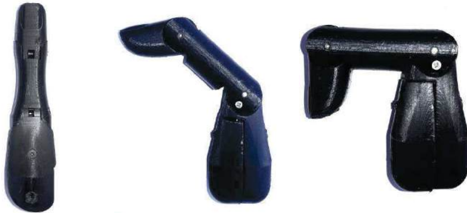
Figura 14. Dedo pulgar robótico multi-articulado antropométrico y antropomórfico construido en material PLA mostrando el movimiento de flexo extensión.
