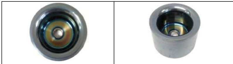
Figura 13. Matriz de acero D2 con recubrimiento de c-AlCrN.
