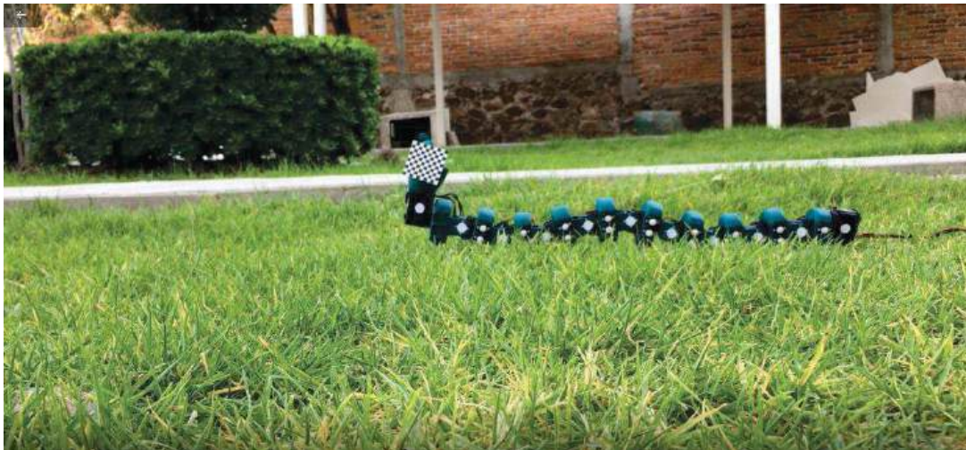
Figura 17. Robot gusano desplazándose en el pasto.
