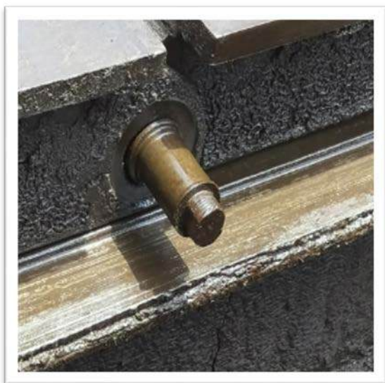
Figure III.3. Fissure de l'axe
