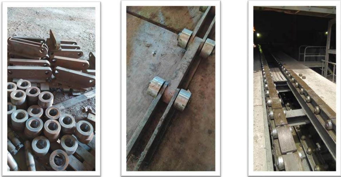
Figure III.6. Montage de la chaîne convoyeur bobine
