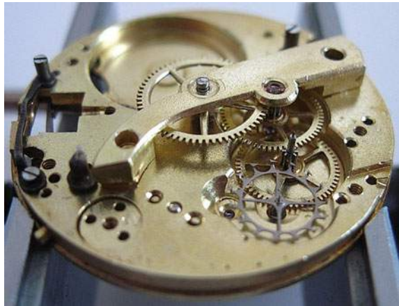
Fig. 2.28 Zylinderwerk 2 using cylinder escapement
