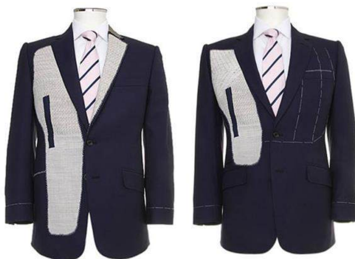
Figura 4.3 - Lado esquerdo: blazer construído com crina na totalidade. Lado direito: blazer construído com metade da crina.
