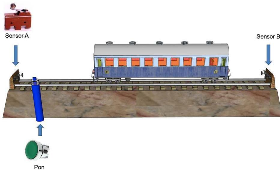
Figura 6.23: Sistema de control de una vagoneta
