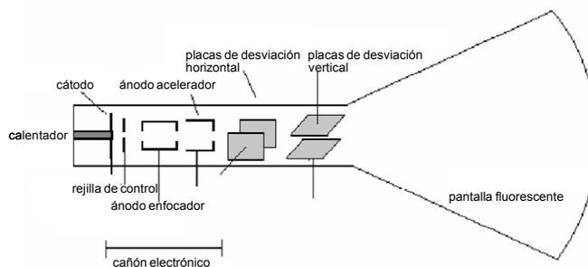
Entre el ánodo y el cátodo existe una diferencia de potencial. El ánodo está a mayor potencial que el cátodo. Dicho de otra manera: el ánodo es positivo y el cátodo es negativo. Por lo tanto entre estos elementos hay un campo eléctrico cuyas líneas “nacen” en el ánodo y terminan en el cátodo. Para que la explicación resulte más sencilla vamos a suponer que este campo es uniforme. Los electrones son “arrancados” del cátodo por una
