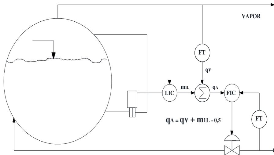
Ilustración 275 “Esquema de control de caldera por Feedforward”
