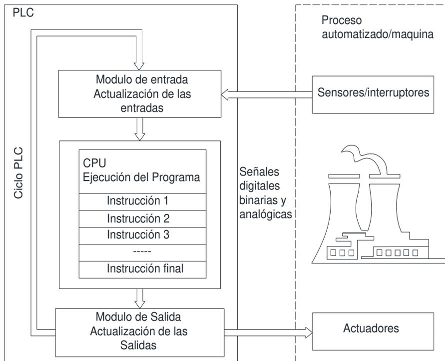
Ilustración 155 “Funcionamiento del Ciclo de un PLC”
