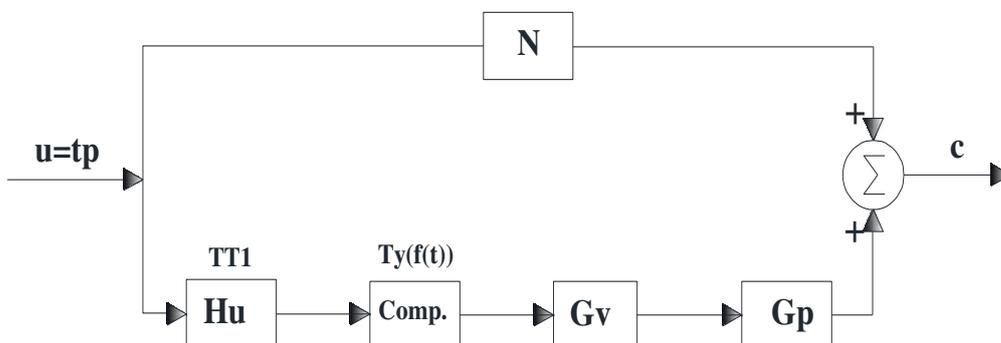
Ilustración 240 "Diagrama de bloque proceso industrial control prealimentado"
