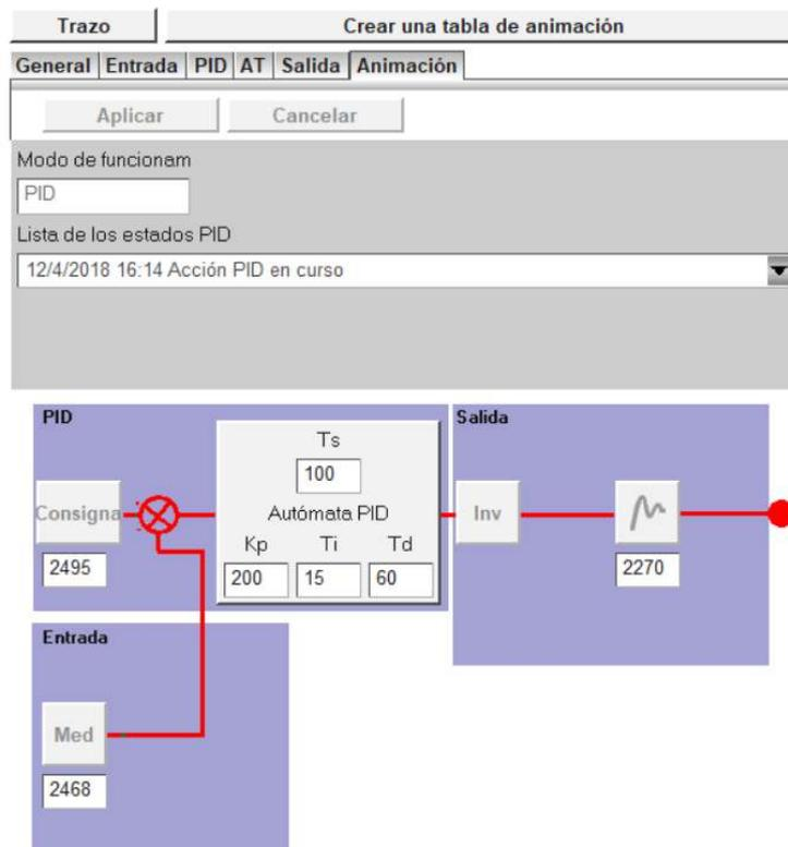
Ilustración 220 “Configuración PID - (Electric, TwidoSuite 2.31.04, 2019)”
