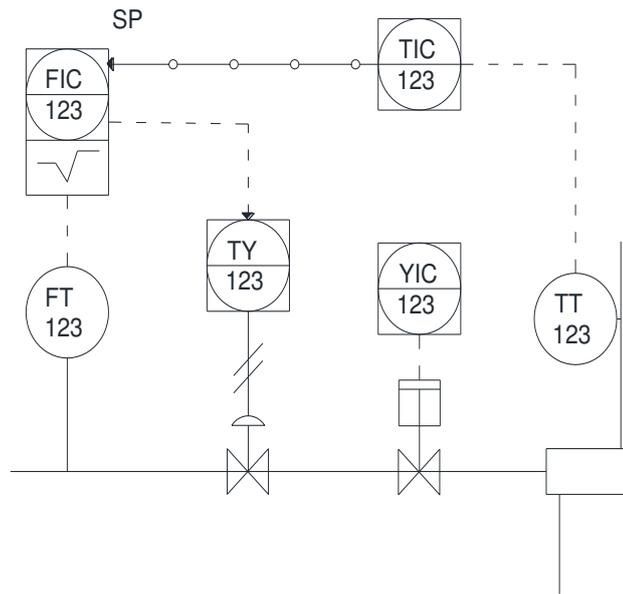
Ilustración 36 “Ejemplo de representación de un lazo”
