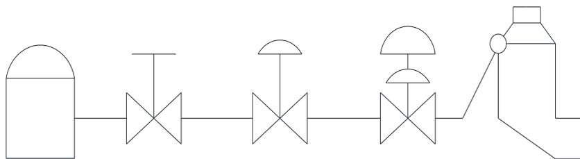
Ilustración 263 “Representación circuito de agua del economizador”
