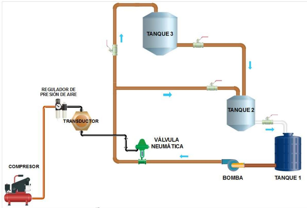
Ilustración 202 “Lazo de control del laboratorio”
