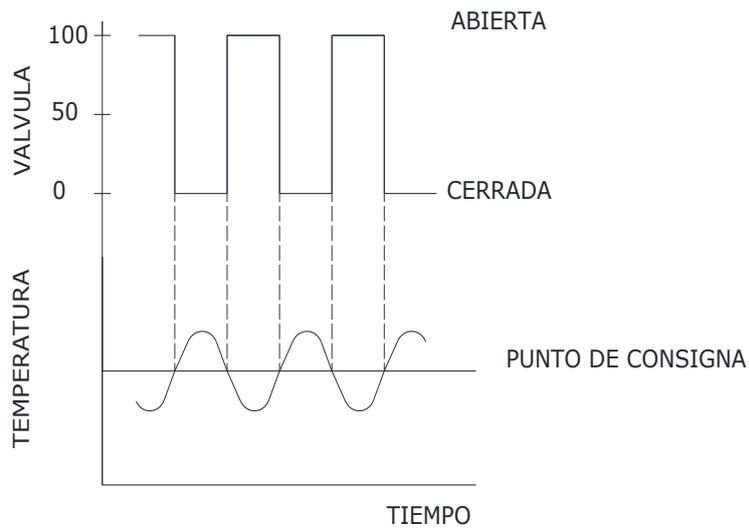
Ilustración 63 “Grafico-sistema control de temperatura - Negative feedback”
