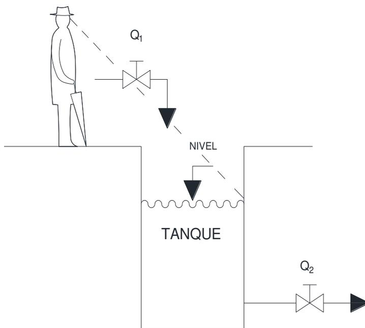
Ilustración 1 “Sistema de control a lazo cerrado”
