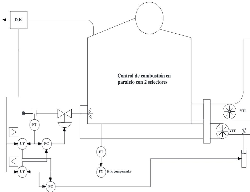
Ilustración 269 "Representación del control de combustión"
