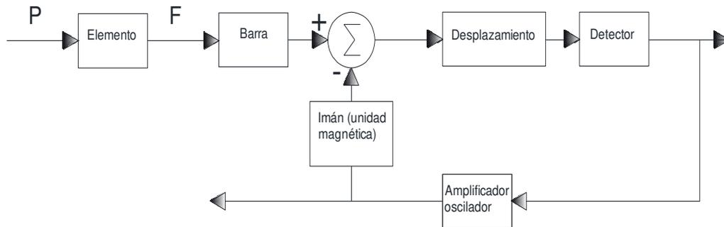
Ilustración 139 “Diagrama de bloque del transmisor electrónico”
