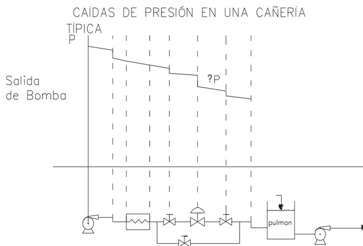
Ilustración 102 "Caída de presión en válvula de control"
