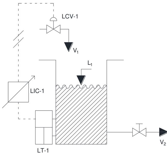
Ilustración 2 “Lazo cerrado automático control de nivel”
