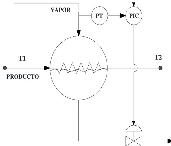
Ilustración 247 “Condensador-lazo automático de control de nivel-Presión
