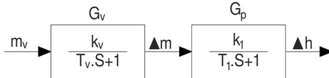
Ilustración 54 “Diagrama del bloque del sistema de control de nivel”
