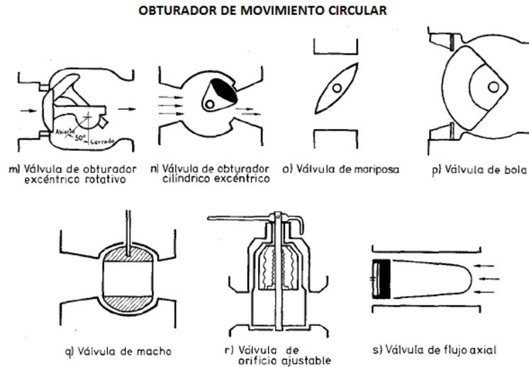
Ilustración 108 “Tipos de Obturadores Circulares (Creus Sole , 1997)”
