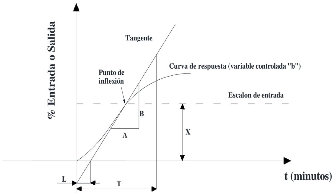
Ilustración 87 "Gráfico de velocidad de reacción"
