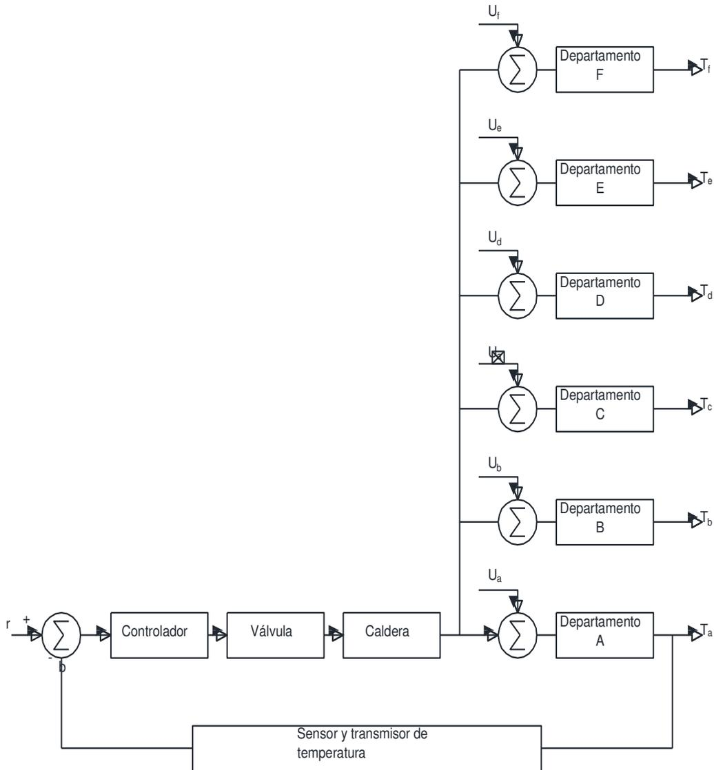
Ilustración 7 “Sistema de calefacción- diagrama de flujo”
