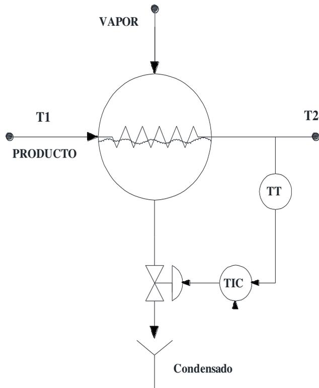
Ilustración 246 “Condensador-lazo automático de control de nivel-temperatura
