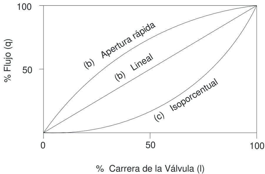
Ilustración 118 “Tipos de características inherentes de la válvula”
