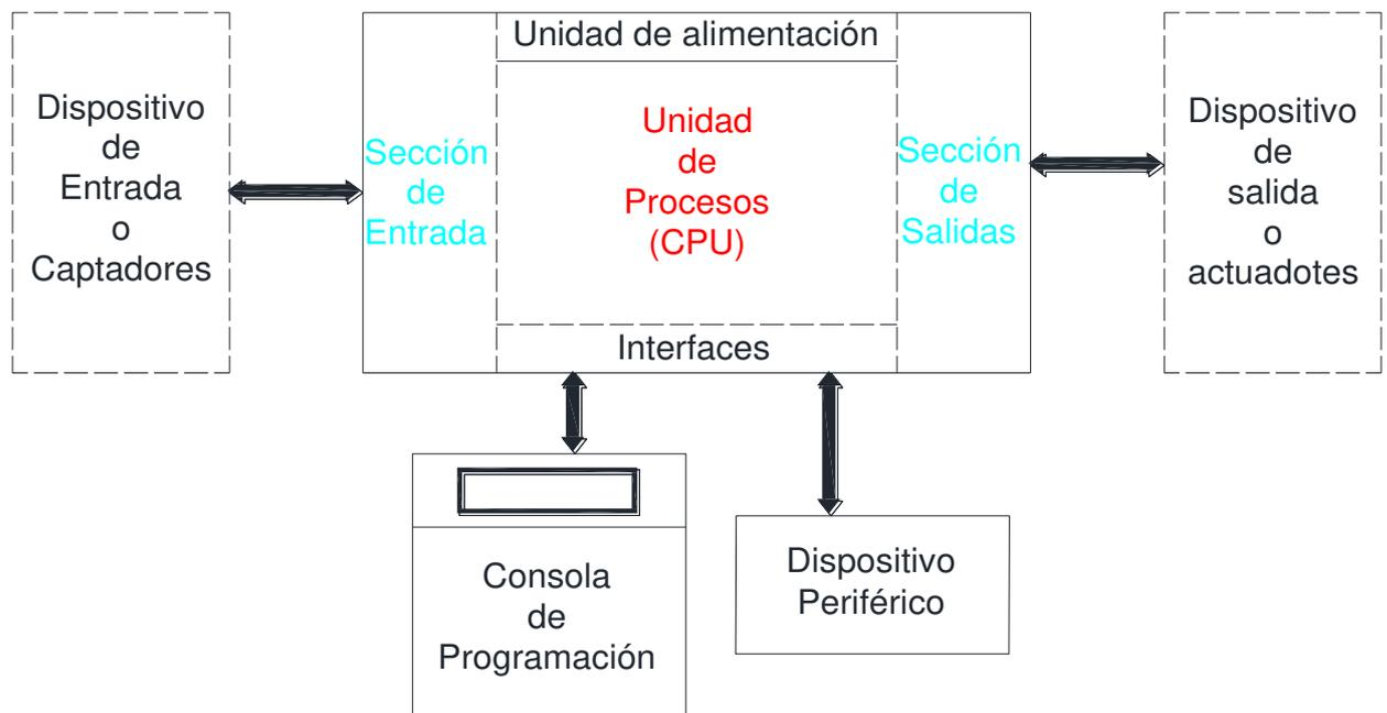
Ilustración 149 “Estructura del PLC”
