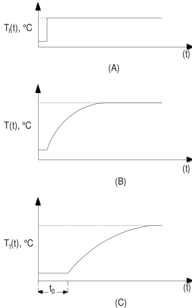
Ilustración 48 “ (A) Señal Entrada aplicada al sistema de control, (B) Señal de la temperatura ambiente, (C) Señal de salida del sistema de control”
