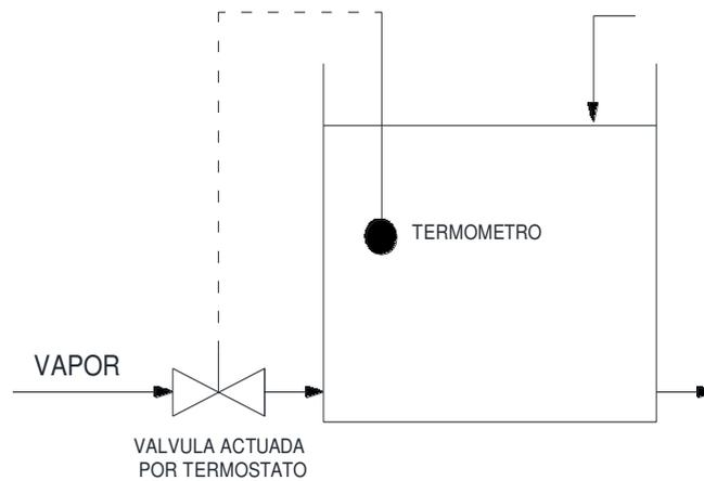
Ilustración 60 “Sistema control de temperatura con inyección de vapor on-off”
