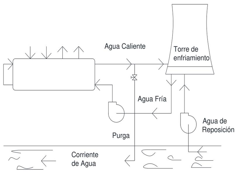
Ilustración 256 “Esquema de instalación de una torre de enfriamiento”
