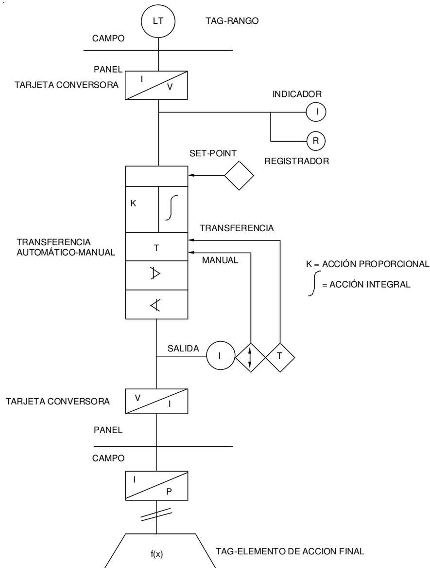
Ilustración 29 “Diagrama de control de domo “
