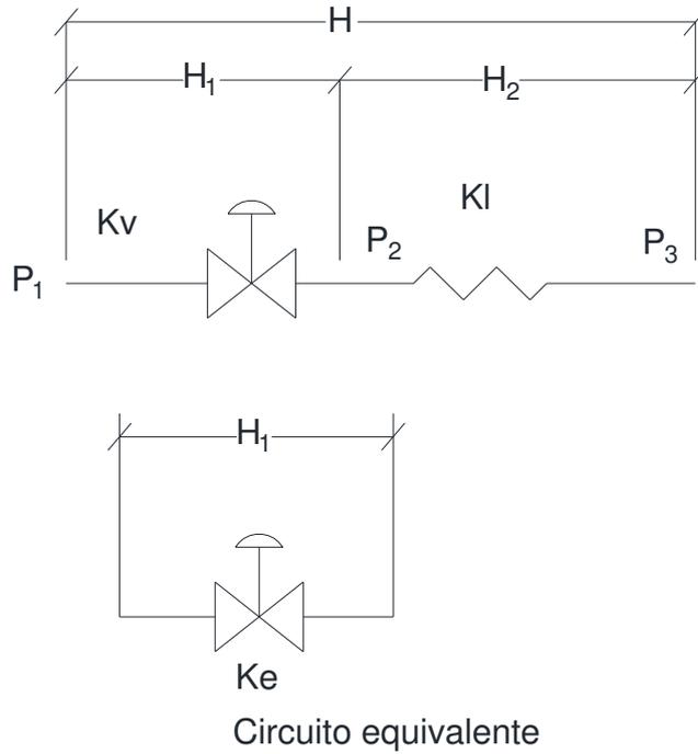
Ilustración 120 “Circuito equivalente para análisis de pérdidas”
