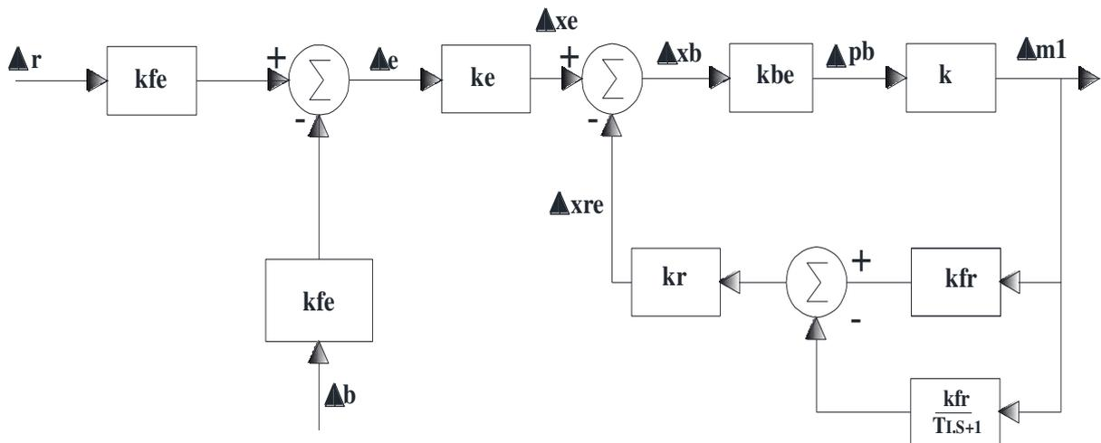
Ilustración 79 “Diagrama en bloques del controlador P+I”
