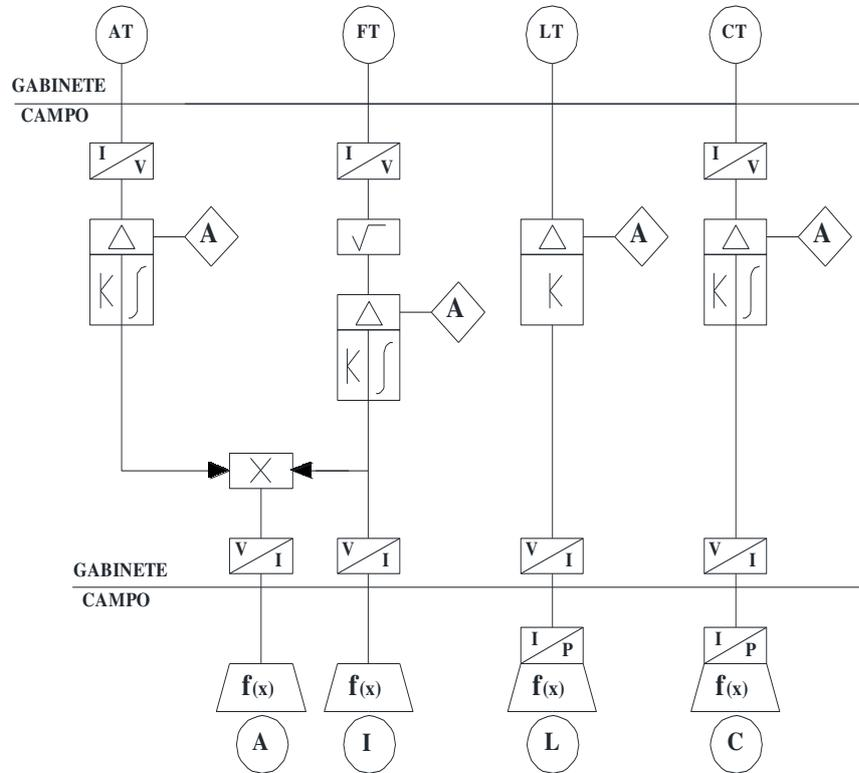
Ilustración 258 “Representación del lazo de control de la torre de enfriamiento”
