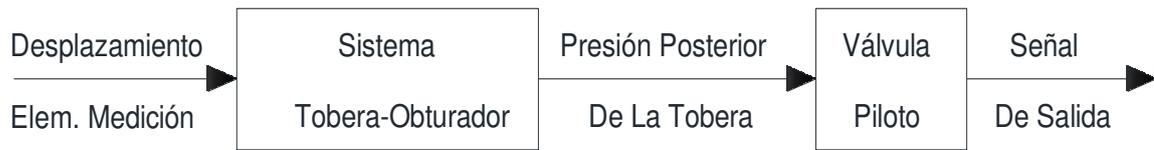
Ilustración 132 “Diagrama de bloque, del amplificador en dos etapas”
