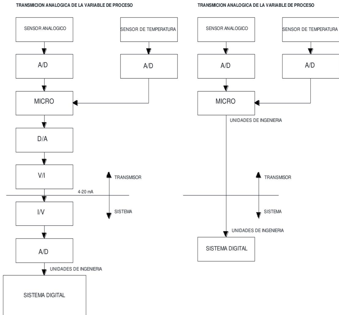
Ilustración 146 "Diagrama de flujo Transmisor inteligente"
