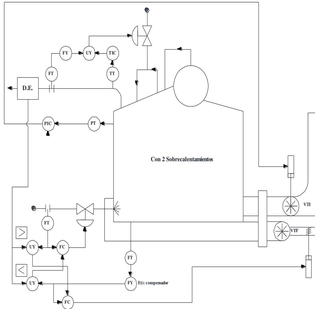
Ilustración 273 “Esquema de control de ciclo con dos sobrecalentamiento”
