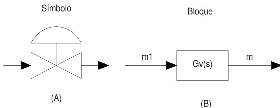
Ilustración 51 “(A) Válvula, (B) Diagrama de bloque “
