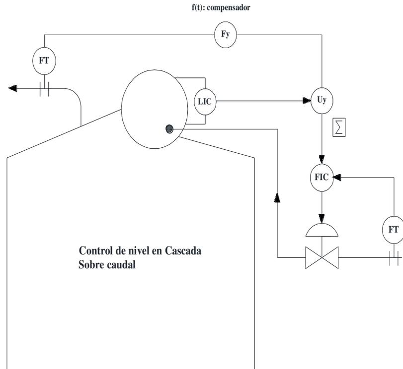
Ilustración 272 “Representación de control del nivel en cascada”
