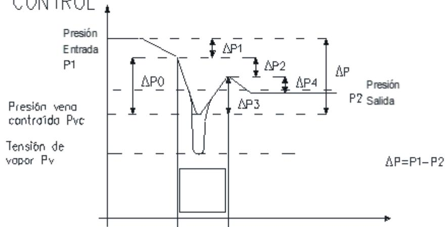
Ilustración 103 “Caída de presión en la válvula”
