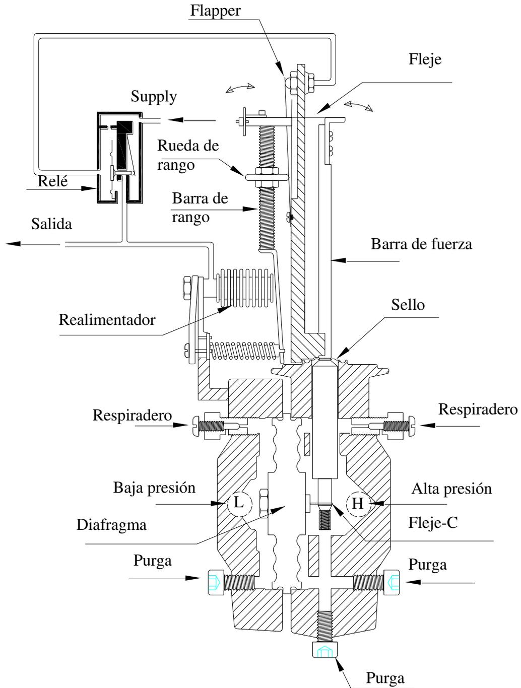
Ilustración 137 "Transmisor Neumático, modelo 11GM-BSA; (Foxboro, 2002)"
