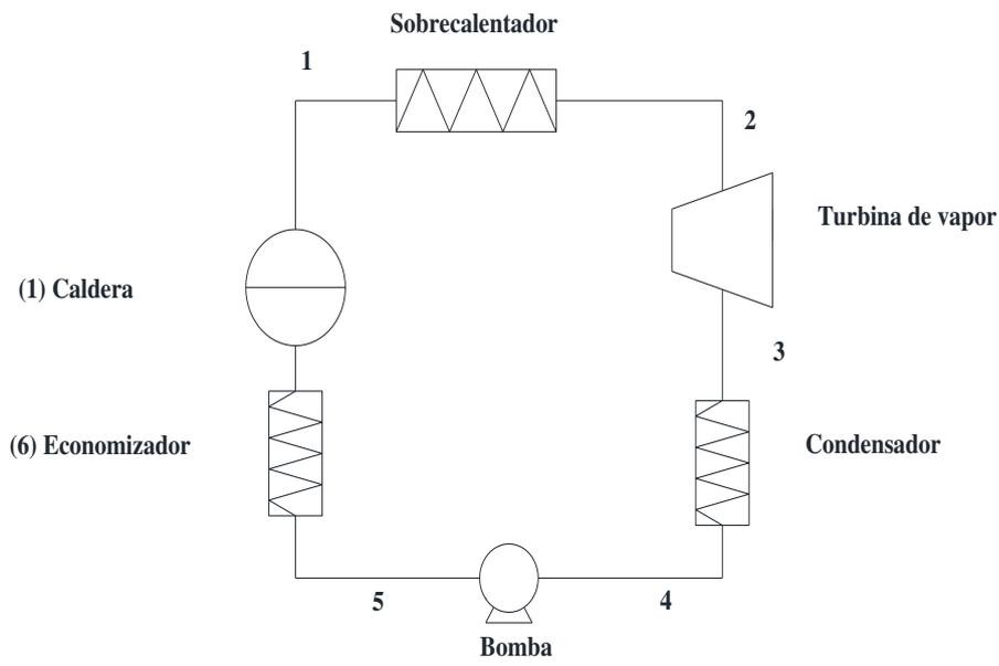
Ilustración 259 “Esquema Ciclo potencia de vapor “
