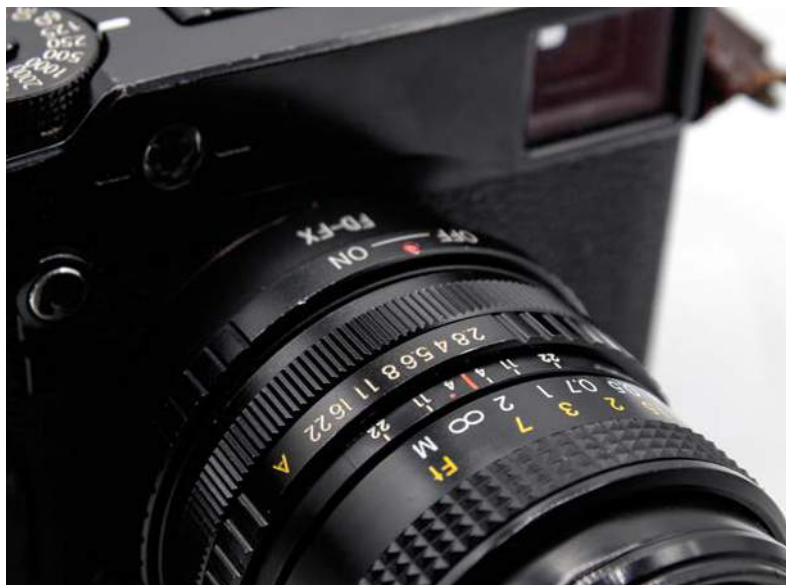
Objetivo Zeiss 24mm f.2.8 Objetivo traído de fotografía analógica. Podemos ver perfectamente como lleva impresa la escala de profundidades de campo en función de el diafragma utilizado. La escala indica el valor de la profundidad de campo por delante y por detrás del punto de enfoque.
