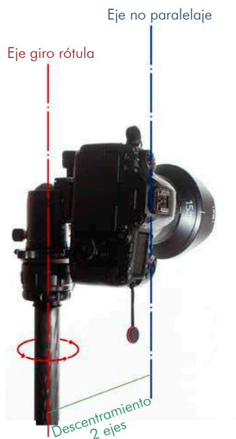
Cámara basculada, descentrada en 2 ejes
