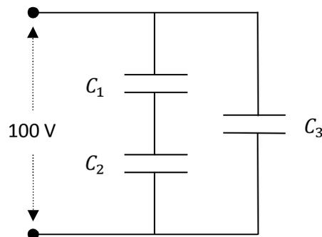
vemos, como já indicado no problema 8, que os condensadores 1 e 2 estão em série entre si e a sua associação está em paralelo com o condensador 3. Ora a d.d.p. aos terminais da associação  $C_{12}$  é então igual à d.d.p. aos terminais de  $C_3$ . Com isto temos  $V_3 = 100 \text{ V}$  e
