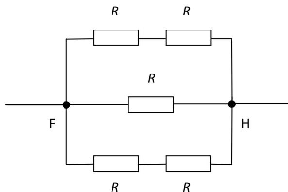
Apresentado desta forma, é agora claro como proceder. As resistências no topo e base estão em série entre si e, de acordo com as regras para associações em série, portanto podemos substituí-las pela sua resistência equivalente,  $R_{eq} = R + R = 2R$ . O circuito FH simplifica novamente para
