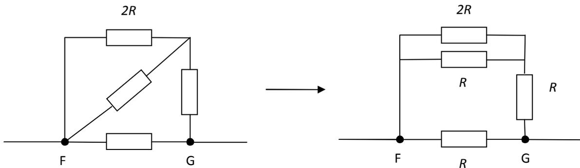
É agora claro que as duas resistências do topo estão em paralelo, para uma  $R_{eq} = \left( \frac{1}{2R} + \frac{1}{R} \right)^{-1} = \frac{2}{3}R$ . O circuito volta a simplificar para
