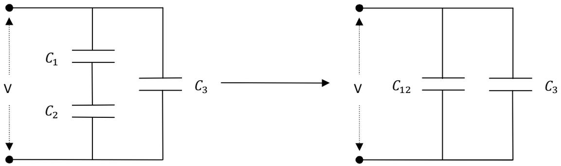
É agora imediato ver que  $C_{12}$  e  $C_3$  estão em paralelo e podemos calcular a capacidade equivalente dos três condensadores,  $C_{eq,123}$ , que designaremos por  $C_{123}$
