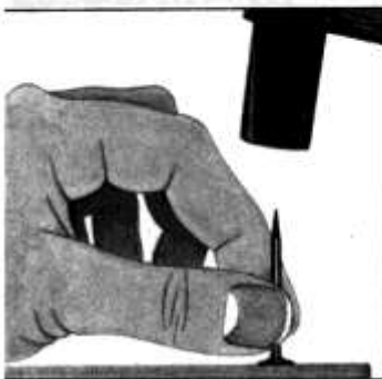
Embotado de punta: se evita agrietado
