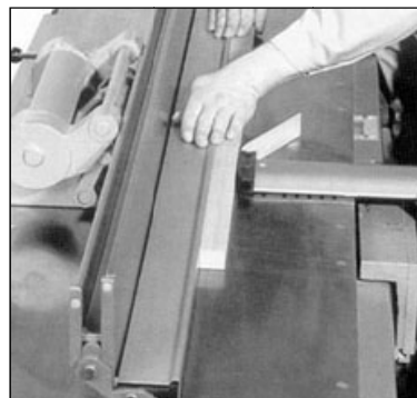
Labrado de pieza corta
