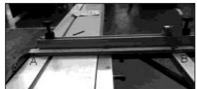
1º Corte transversal de la testa Tope lateral levantado
