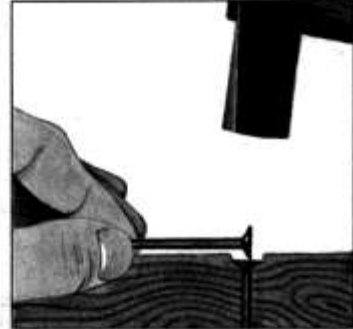
Cabeza de clavo undida
