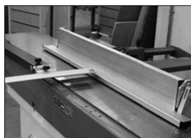
Soporte seguridad para labrar piezas de sección pequeña
