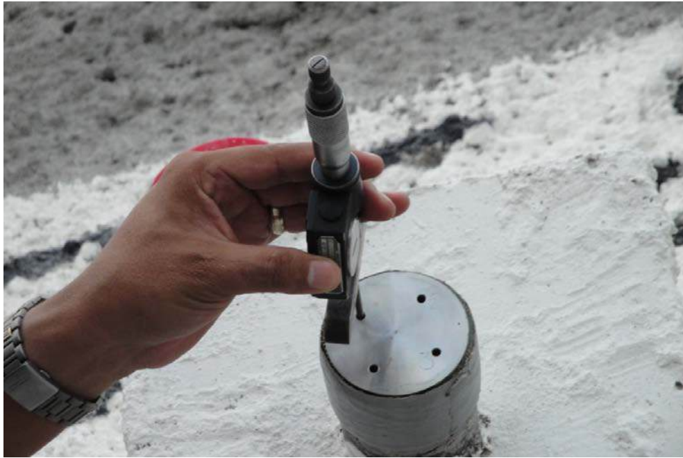
Figura 5.60 Toma de lecturas en un extensómetro interno de barras con un micrómetro digital
