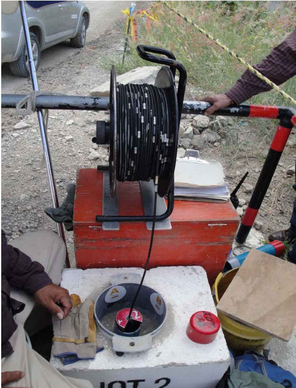
Figura 5.7 Toma de lecturas con la sonda del inclinómetro vertical sin utilizar polea
