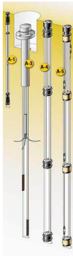
Figura 5.56 Tipos de extensómetros internos de barras
