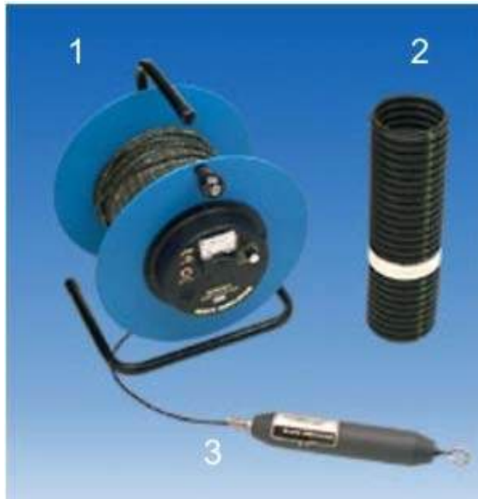
Figura 5.66 Deformómetro de anillos magnéticos (Sondex): 1) Carrete eléctrico graduado, 2) Tubo corrugado con anillos de acero inoxidable y 3) Sonda (cortesía de Slope Indicator)
