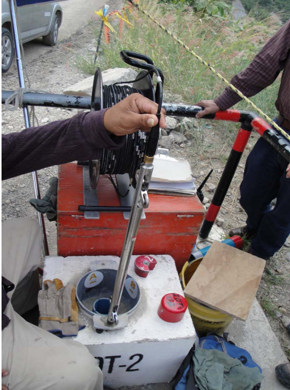
Figura 5.24 Operación en campo de una sonda para inclinómetro vertical
