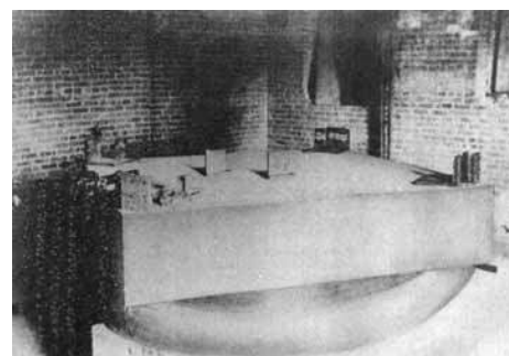
Interferómetro utilizado por Michelson y Morley para medir la velocidad de la luz.
