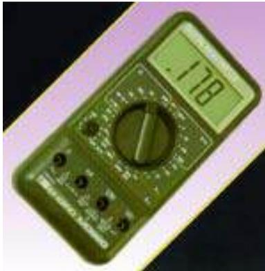
Instrumento utilizado para medida da tensão elétrica (voltagem) composto por duas ponteiros através da qual devem ser ligadas em paralelo pois mede a diferença de potencial entre dois pontos. Tem como característica uma impedância de entrada elevada.
