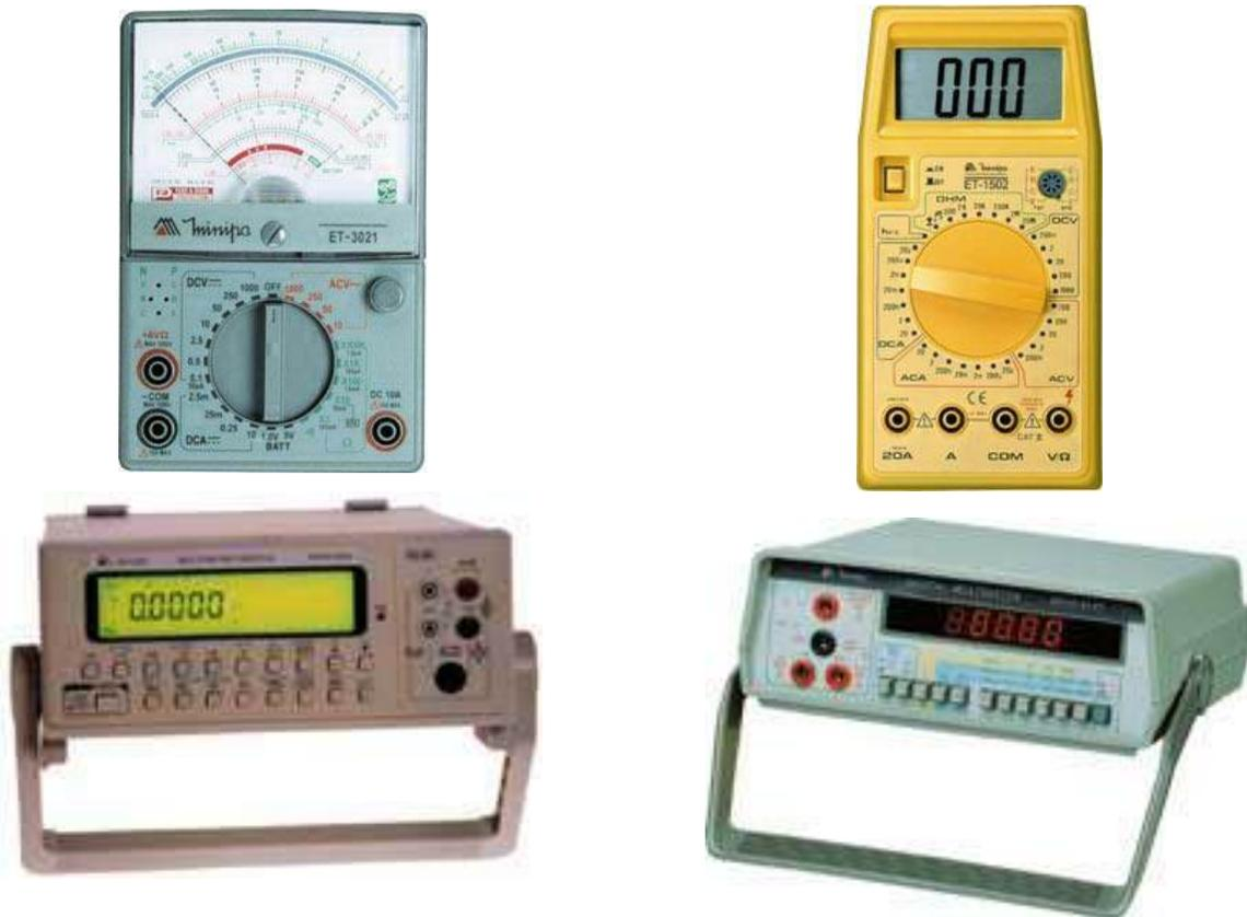
Instrumento de medida multifuncional que reúne a função de voltímetro, ohmímetro e amperímetro.
