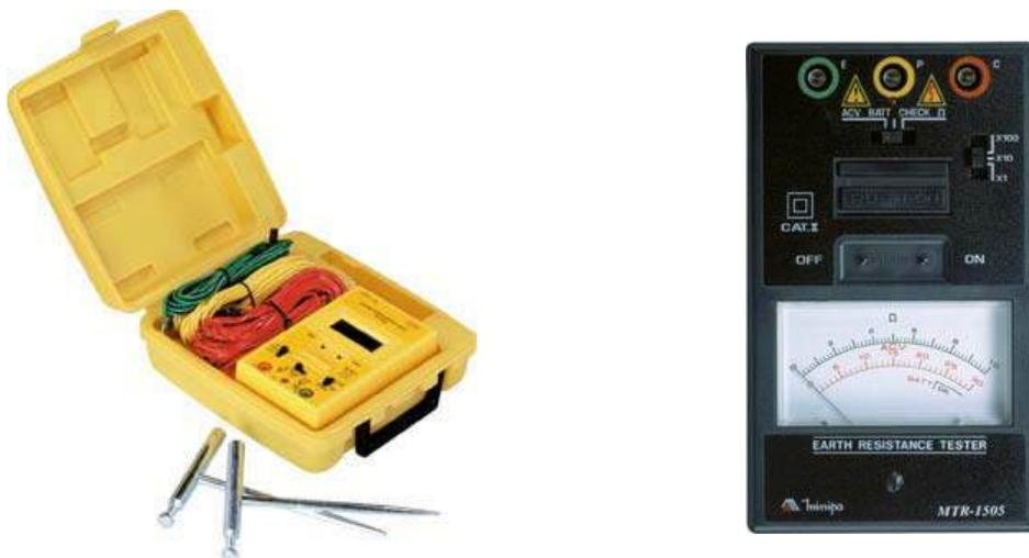
Instrumento utilizado para a medição da resistividade do solo.
