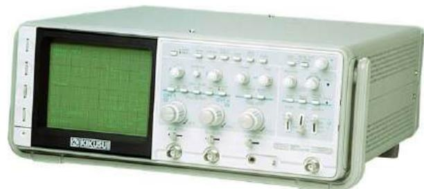
Instrumento que além de medir tensão, frequência, etc..., possibilita visualizar a forma de onda do circuito em medição. São dotados de dois ou quatro canais que possibilitam fazer a medição simultânea.
