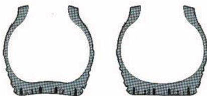
Pneu vazio à esquerda e cheio à direita, apresentando maior área de contato da banda de rodagem.
