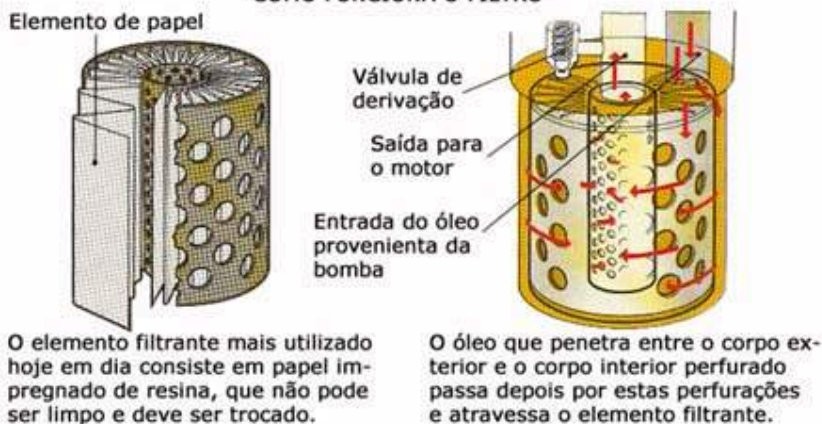
Sistema normal de filtração total. Todo óleo passa através do filtro. Sistema de derivação. Apenas uma parte pequena do óleo passa através do filtro.
