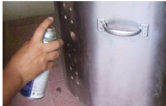
La pintura usada es una especial para “altas temperaturas” que soporta hasta 600°C, suficiente para el calor exterior del horno y esta disponible en latas de aerosol o en tarros para aplicar con brocha o aerógrafo en cualquier ferretería.
