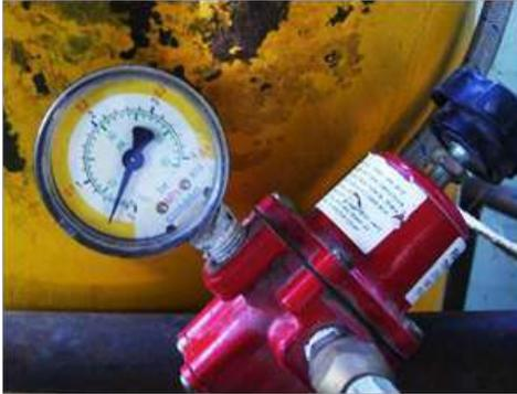
Es importante mantener un control durante las quemas aumentando la presión (salida de gas), en intervalos de 30 minutos ayudando a potencia la flama, la regulación será más lenta si se trata de una quema de bizcocho mientras que en una quema de vidriado el aumento de la presión puede ser más rápido.
