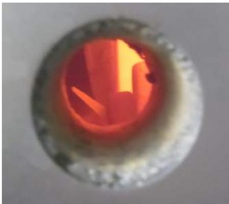
Por medio de las mirillas que se encuentran en el cuerpo del horno es posible monitorear si los conos pirométricos han fundido alcanzando así las piezas colocadas dentro del horno su temperatura ideal
