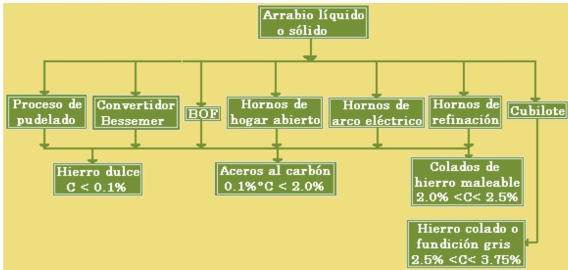
En hornos de refinación, los que pueden trabajar mediante inducción eléctrica o de crisol de aire, se producen calados de hierro maleable.
