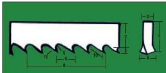
Las sierras manuales suelen tener 14, 16, 18, 22 y 32 dientes por pulgada. La elección de la hoja de sierra vendrá determinada por la dureza y espesor del material a cortar. Para metales duros iremos por sierras de paso pequeño (de 22 a 32 dientes por pulgada). Para metales de dureza media (trabajos normales), tomaremos hojas de 16 a 22 dientes.
