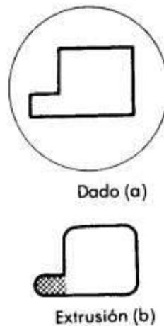
Si la abertura del dado consta de un barreno circular y paralelo, es decir, la longitud del soporte es igual al espesor del dado, la extrusión será una varilla circular que requiere una fuerza considerable para estirla y tiene una pobre superficie de acabado. La superficie de acabado puede mejorarse y disminuir la carga, aumentando el diámetro del barreno en el extremo de descarga.
