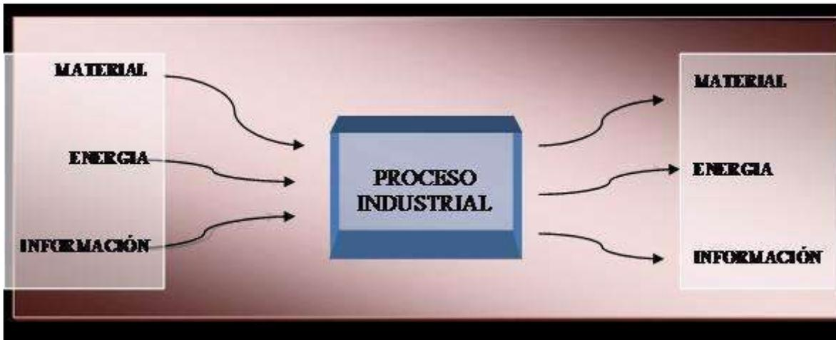
Este diagrama conforma el modelo básico de proceso, en donde los elementos de entrada son transformados en una unidad de proceso para obtener otros elementos de salida con las especificaciones requeridas.
