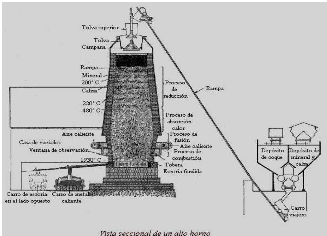
Los altos hornos pueden producir entre 800 y 1600 toneladas de arrabio cada 24 h. La caliza, el coque y el mineral de hierro se introducen por la parte superior del horno por medio de vagones que son volteados en una tolva. Para producir 1000 toneladas de arrabio, se necesitan 2000 toneladas de mineral de hierro, 800 toneladas de coque, 500 toneladas de piedra caliza y 4000 toneladas de aire caliente.
