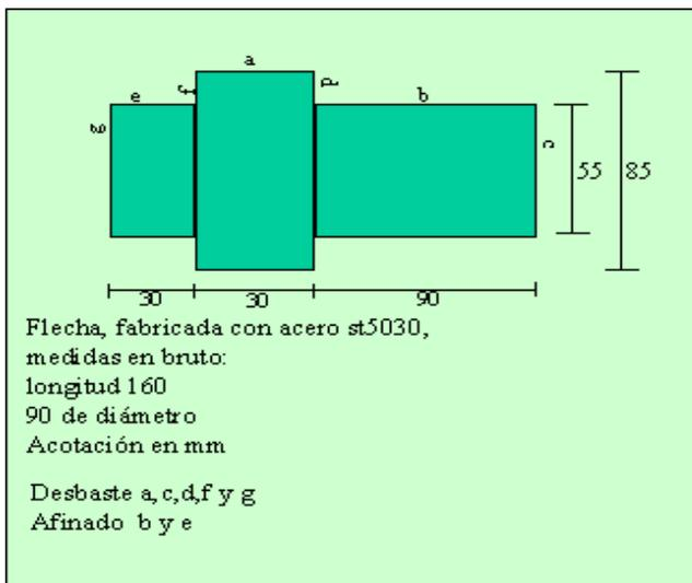
Partiendo de la longitud original, se estima una porción anterior ( $l_a$ : 5) y otra ulterior ( $l_u$ : 1), que habrán de rebajarse a lo largo, para dar la longitud final de la pieza (150 mm). La velocidad de corte, avance y profundidad se encuentran en tablas como la 15, en correspondencia al tipo de acero y la herramienta; a una velocidad de
