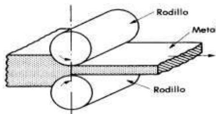
Este proceso de deformación puede llevarse a cabo, ya sea en caliente o en frío. El trabajo en caliente es usado muy ampliamente porque es posible realizar un cambio en forma rápida y barata.
