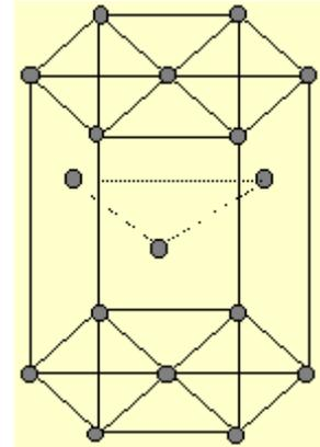
Modificar a una malla de un metal permite la participación de más átomos en una sola molécula, estos átomos pueden ser de un material aleado como el carbón en el caso del hierro, lo que implica que se puede diluir más carbón en un átomo de hierro. Si se tiene en cuenta que el carbón es el que, en ciertas proporciones, da la dureza al hierro, entonces lo que se hace al cambiar la estructura del hierro es permitir que se diluya más carbón, con lo que se modifican sus propiedades.
