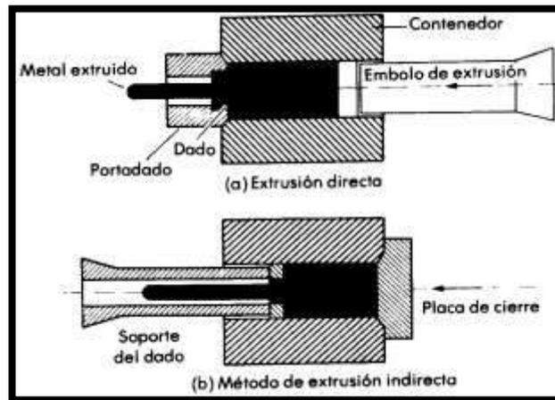
El metal expulsado o extruido toma la forma del orificio del dado. El proceso puede llevarse a cabo por dos métodos llamados: extrusión directa, donde el émbolo está sobre el lingote en el lado opuesto al dado y el metal es empujado hacia el dado por el movimiento del émbolo Fig. 41 (a), o extrusión indirecta, en la cual el dado y el émbolo están del mismo lado del lingote y el dado es forzado dentro del lingote, por el movimiento del émbolo.
