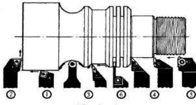
Tipos en la gráfica: 1. Cilindrado 2. Refrentado 3. Copiado Hacia fuera Hacia dentro 4. Cortes perfilados 5. Roscado 6. Tronzado
