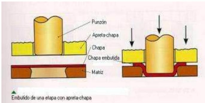
El desplazamiento del material en ese instante es semejante al flujo de agua por el rebosadero de una presa. Cuando se pretende que el espesor del material no se altere durante el proceso de embutido, el área de la
