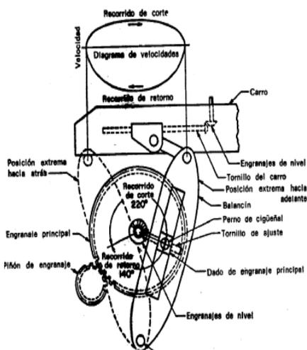
Para el vaivén del carro se usa una corredera oscilante con un mecanismo de retorno rápido. Los cepillos de codo son también conocidos como máquinas mortajadoras horizontales, pueden trabajar piezas de hasta 800mm de longitud y generan acabados de desbaste ( $\tilde{N}$ ) o de afinado ( $\tilde{N}\tilde{N}$ )
