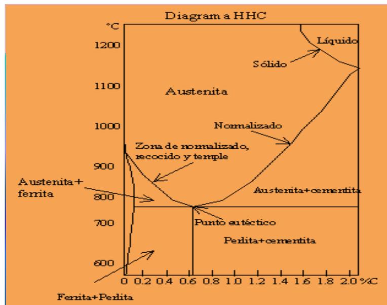
En el eje horizontal del diagrama de Hierro, hierro, carbono se ubica el porcentaje de carbono que puede estar diluido en el hierro y en el eje vertical se señalan las temperaturas a las que van sucediendo los cambios señalados en el cuerpo de la gráfica.
