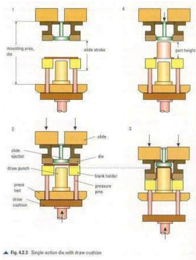
Seguido se expulsa la pieza embutida por acción de un expulsor, obteniéndose una pieza de esta característica
