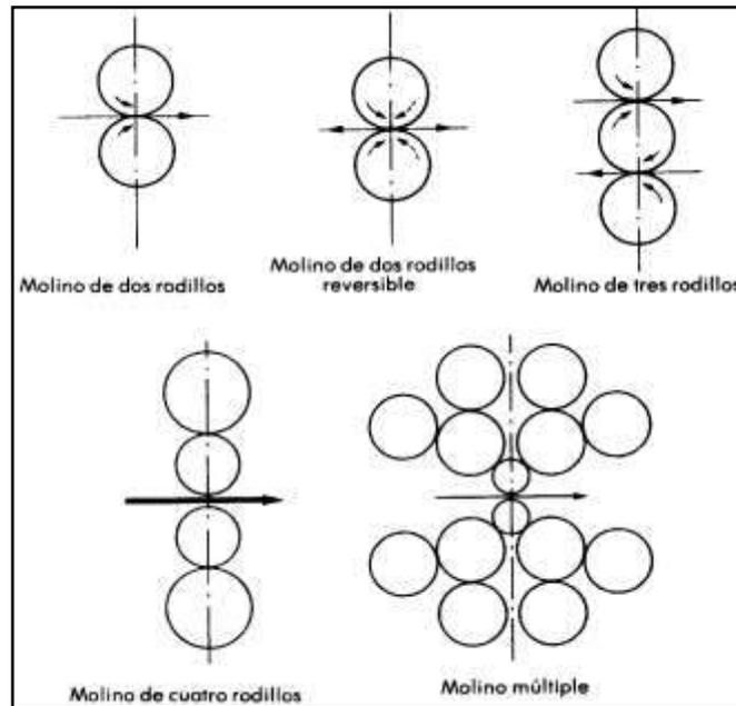
Esta puede ser de acuerdo al arreglo de los rodillos en el bastidor en el molino o de acuerdo con el arreglo de los bastidores en secuencia. Los molinos de laminación se clasifican de acuerdo a la Fig. 39. El molino de dos rodillos fue el primero y el más simple pero su capacidad de producción tiende a ser baja debido al tiempo que se pierde al tener que regresar el metal al frente del tren o molino.
