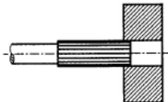
Normalmente los taladrados se rematan por medio de operaciones de escariado, que se llevan a cabo para obtener un buen acabado interior del taladrado. El
