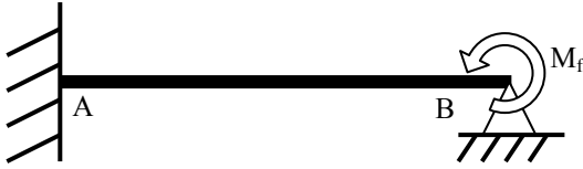
FIG. 1.2. Disposición para medir la rigidez flexional.
