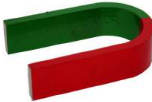
Figura 8.2.: Íman em forma de ferradura. O polo norte está pintado de vermelho.
