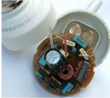
Figura 9.11.: Circuito de lâmpada.
