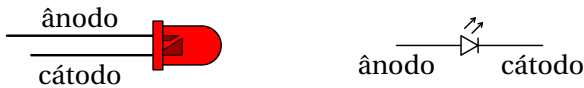
Figura 12.13.: LED e diagrama de circuito correspondente. O cátodo costuma ser um fio mais curto e estar perto de uma zona onde a cobertura plástica é plana.
