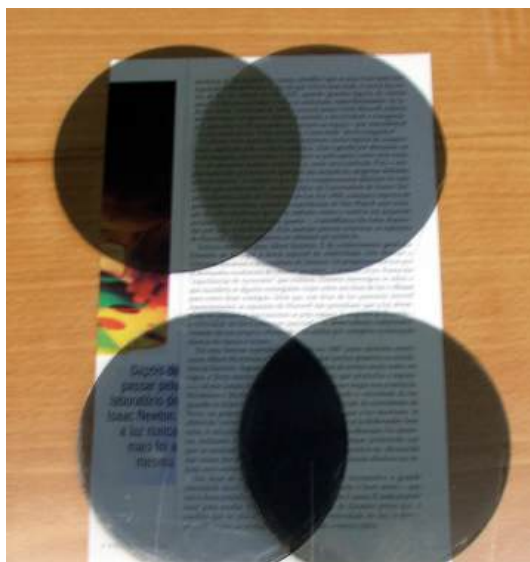
Figura 12.11.: Dois filtros polarizadores com os eixos paralelos (acima) e com os eixos perpendiculares (abaixo).
