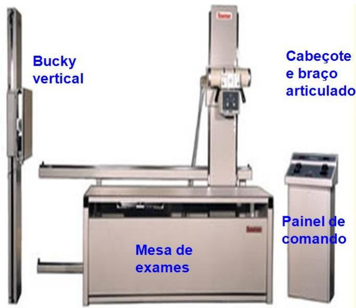
A Figura abaixo ilustra a cadeia básica de aquisição de uma imagem radiográfica, mostrando desde a fonte de radiação, passando pelo paciente colocado sobre a mesa, até o final do processo com o dispositivo de registro da imagem, o filme radiográfico.
