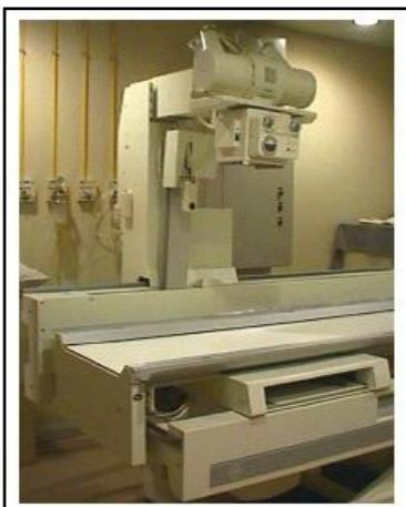
A figura ao lado apresenta a foto de um aparelho telecomandado, que visualmente não apresenta diferenças com um aparelho comum. Isto porque o aparelho telecomandado possui como diferença principal a possibilidade de ajustar todos os parâmetros mecânicos e geométricos (posição da mesa, inclinação, tamanho do campo, etc) a partir da própria mesa de comando, sem a necessidade do técnico tocar na mesa ou paciente.
