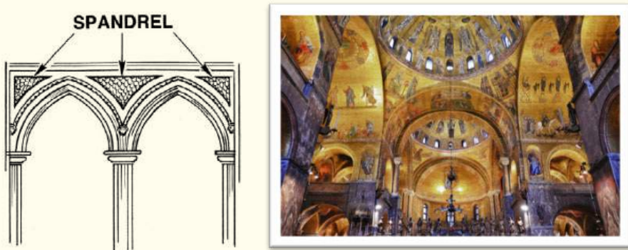
Figura 2. Na esquerda, representação dos spandrels , com seus espaços cônicos “acidentais”. Na direita, uma foto interna da basílica de São Marcos, em Veneza.
