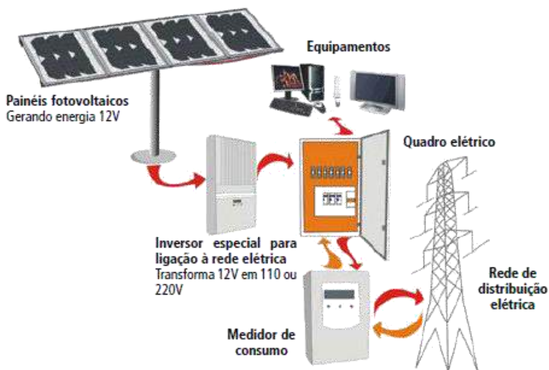
Figura 91: Medidor bidirecional aplicado em sistema FV on grid disponível em: < http://www.metalica.com.br/energia-a-abundancia-solar >, acesso em 14/07/2016.
