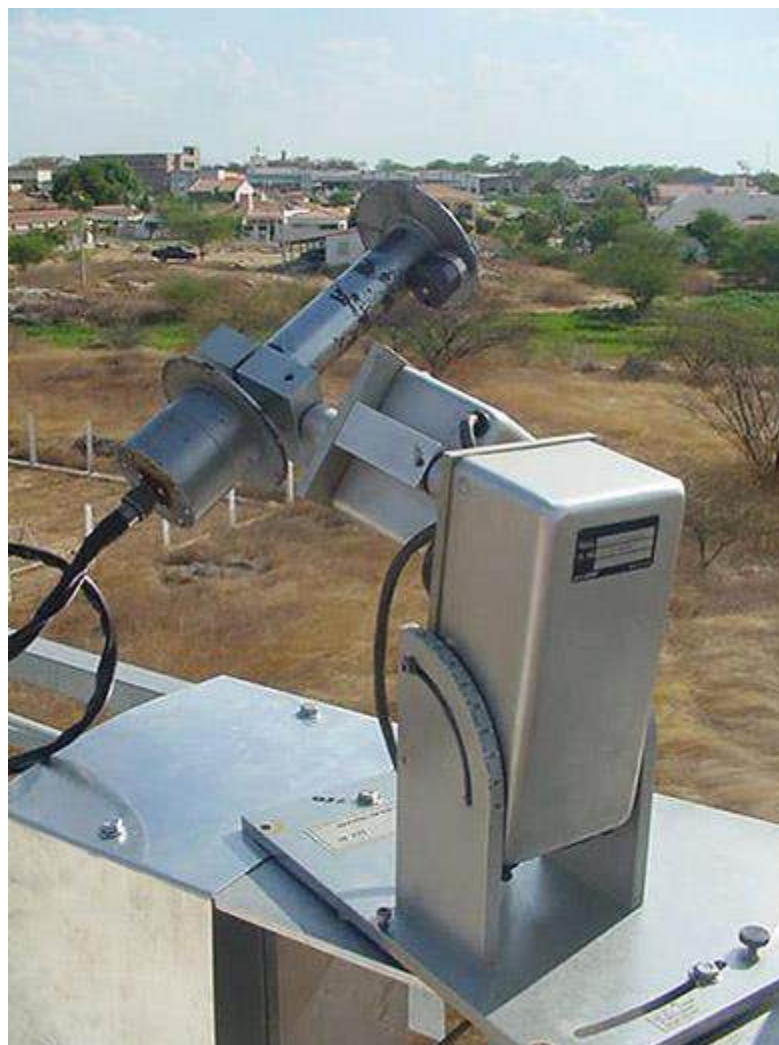
Figura 49: Pireliômetro conectado ao robô rastreador, disponível em: < http://sonda.ccst.inpe.br/fotos/CAI/2002/caico_20.html >, acesso em 06/05/2016.
