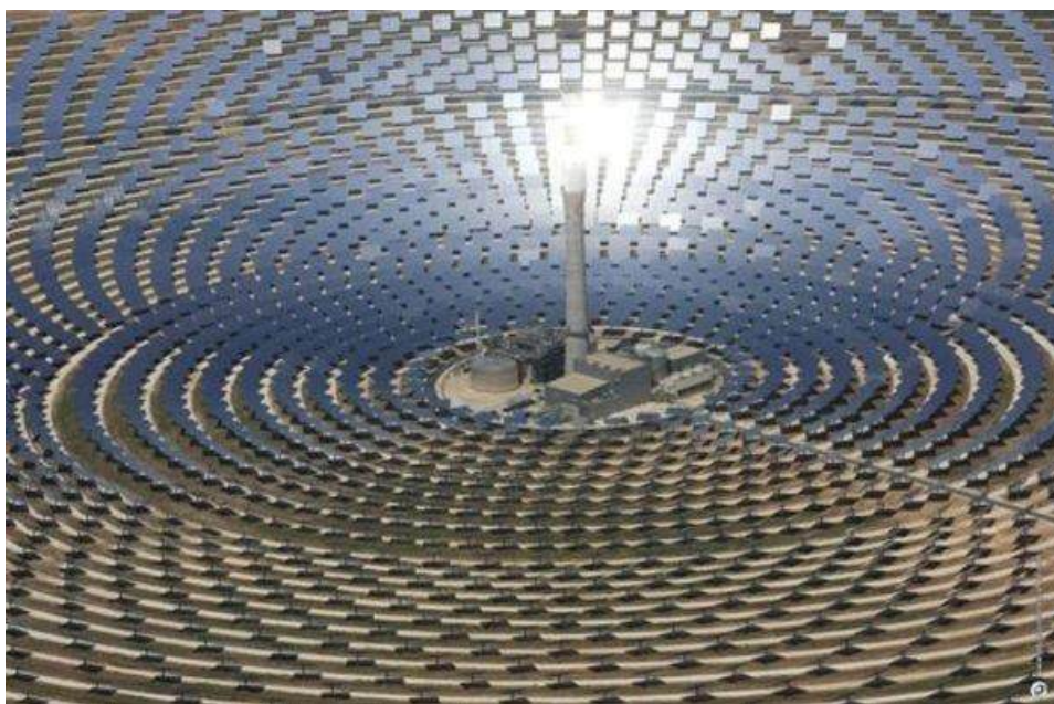
Figura 15: Vista aérea de uma usina solar térmica com concentrador do tipo torre, disponível em: < http://img01.lavanguardia.com/2011/10/04/Vista-aerea-de-la-planta-termo_54226113697_53389389549_600_396.jpg >, acesso em 02/06/2016.
