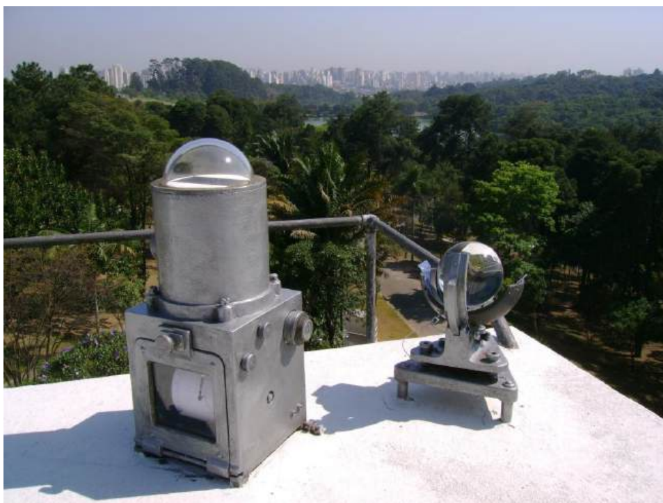
Figura 45: Actinógrafo e heliógrafo, disponível em: < http://meteoropole.com.br/2014/02/detalhe-do-termometro-de-maxima-temperatura-e-informacoes-diversas-sobre-instrumentos-convencionais/ >, acesso em 06/05/2016.
