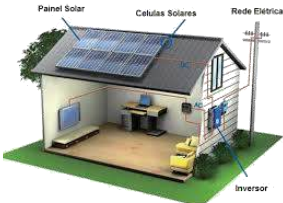
Figura 85: Exemplo de uma aplicação residencial para um sistema FV interligado a rede, disponível em: < http://energiaesol.com.br/energia-solar/ >, acesso em 14/07/2016.
