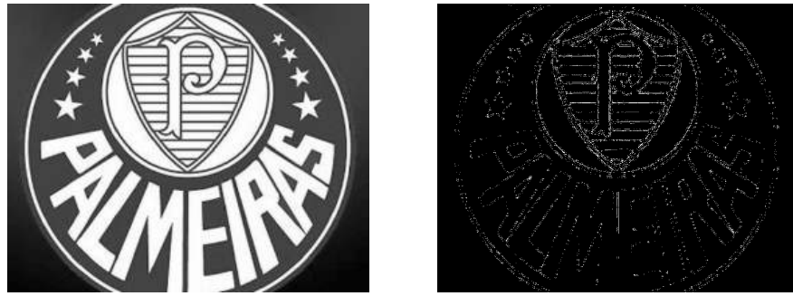
Figura 10.28: Detecção de bordas em uma imagem.
