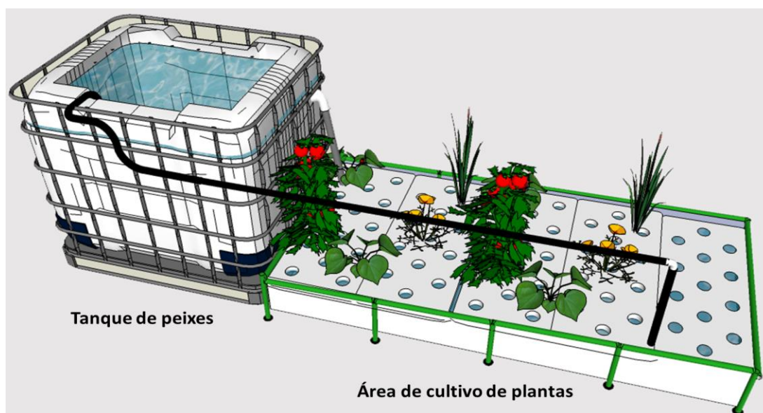
FIGURA 4.76 Ilustração de uma pequena unidade de cultivo em águas profundas sem separador mecânico de sólidos ou biofiltro
