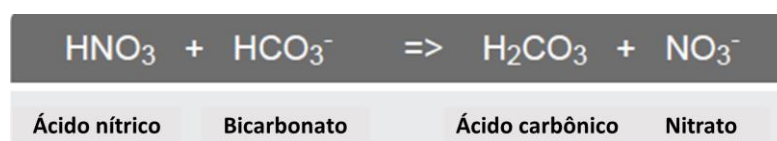
FIGURA 3.7 Bicarbonato e ligação de ácido nítrico em aquaponia
