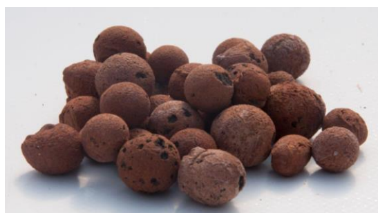
FIGURA 4.55 Pellets de agregado leve de argila expandida, usados como substrato/mídia
