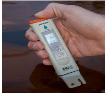
FIGURA 2.8 Medidor digital de pH e temperatura
