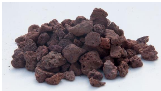
FIGURA 4.53 Tufo vulcânico usado como substrato/mídia
