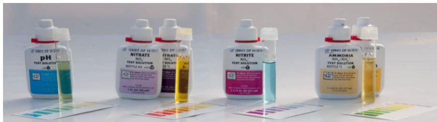
FIGURA 3.13 Kit de teste de água doce para pH, amônia, nitrito e nitrato. Os valores são determinados comparando a cor da água de teste com a do cartão de referência
