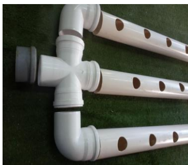
FIGURA 4.64 Vários tubos de crescimento mostrando o espaçamento dos furos
