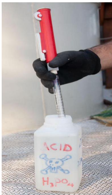
FIGURA 3.11 Ácido fosfórico ( \text{H}_3\text{PO}_4 - concentração de 85 %) usado para baixar o pH
