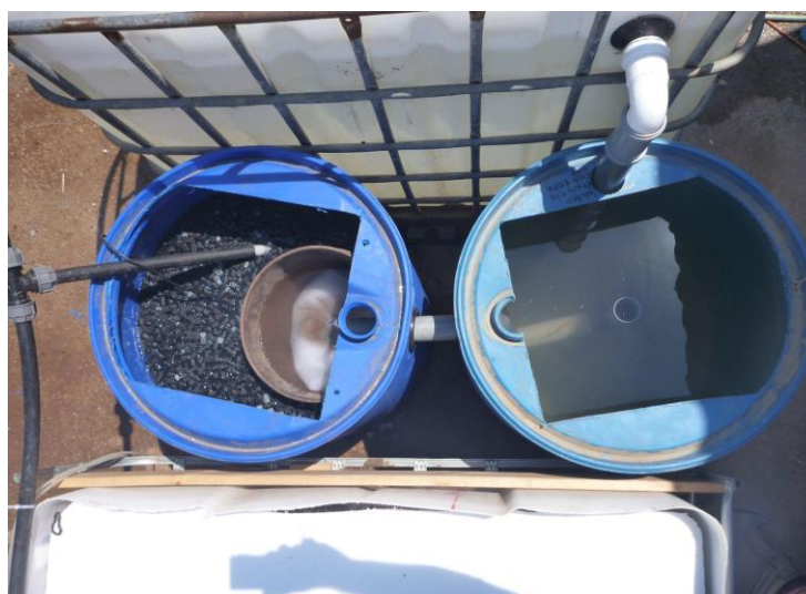
FIGURA 4.34 Vista superior do separador mecânico de sólidos (direita) conectado ao biofiltro (esquerda)
