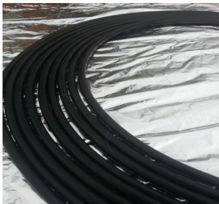
FIGURA 9.11 Técnica de aquecimento de água usando tubo preto disposto em espiral
