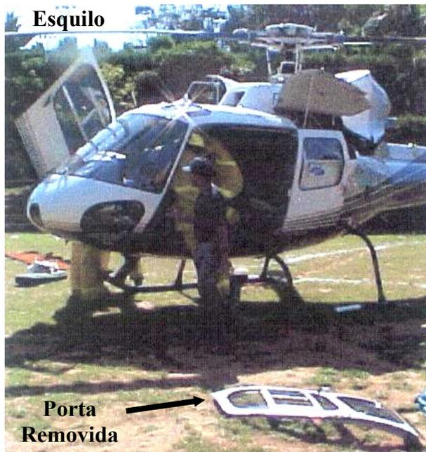
Alguns modelos de helicópteros utilizados para remoção hospitalar possuem portas com ampla abertura localizada na parte de trás da cabina.
