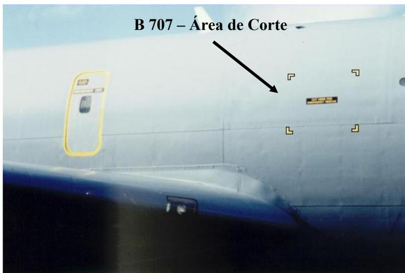
Apesar de existirem essas áreas de corte, dificilmente são utilizadas, pois os aviões de médio e grande porte possuem várias portas e janelas de emergência, além do fato da fuselagem se romper por ocasião de acidentes, permitindo acesso direto.
