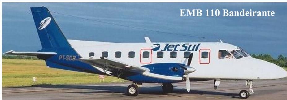
b) **Aviões de Média Altura** - As janelas de emergência ficam em cima das asas.
