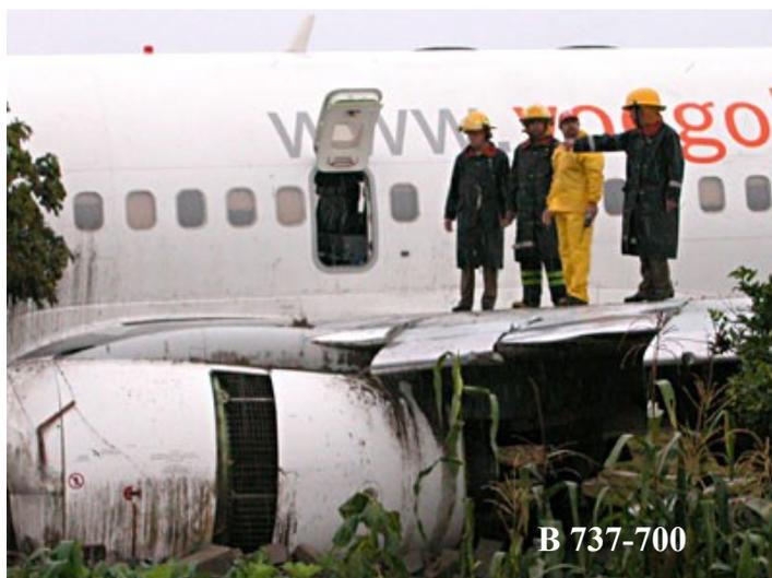
A maioria das rotas de fuga das janelas de emergência sobre as asas é em direção à sua parte de trás (bordo de fuga). Porém existem alguns aviões em que as rotas são em direção à parte da frente (bordo de ataque), devido à proximidade do motor com a asa.
