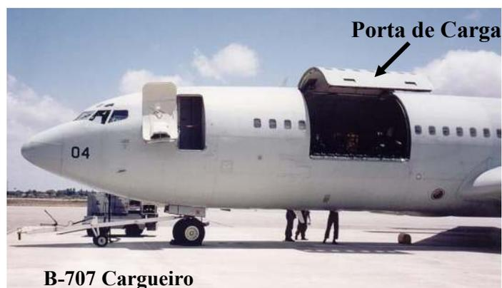
c) **Porão de Carga** – Nos aviões de grande porte as portas do porão de carga ficam no lado direito da fuselagem.
