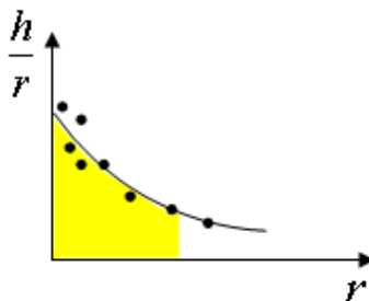
Fig. 12.17: Tratamiento de la integral \int_{r=0}^r \frac{h}{r} \cdot dr . El área bajo la curva representa el valor de la integral que se desea calcular.
