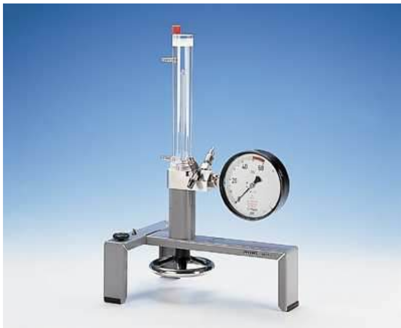
Fig. 4.5: Equipo comercial para la medida de propiedades críticas de sustancias puras.
