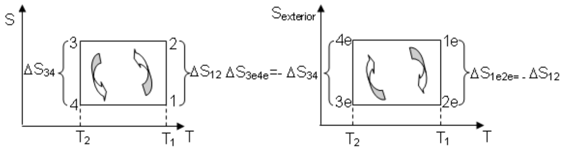
Fig. 7.13: Esquematización de los cambios de entropía en un ciclo reversible de Carnot en un diagrama S-T. Las líneas horizontales corresponden a los procesos adiabáticos reversibles, que por su naturaleza son isoentrópicos.
