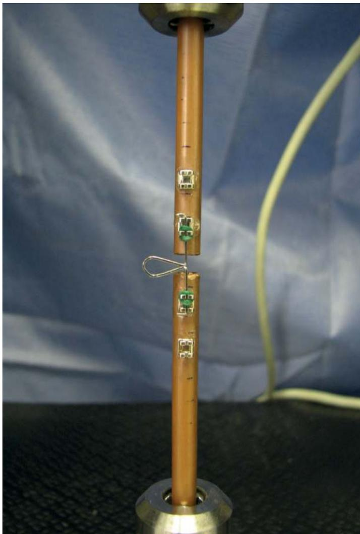
Figura 2 – Alça fixada à máquina de ensaios mecânicos.
