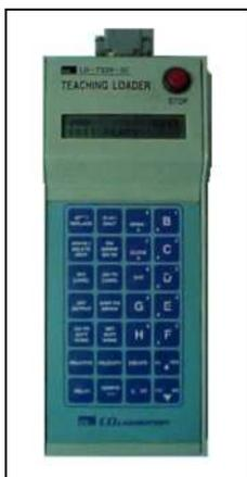
Ao atingir este ponto desejado, ele é gravado nesta posição através de um botão denominado de tecla de registro. Ex.: Tarefas de transferência, carga e descarga de peças em máquina, soldagem a ponto, etc.
