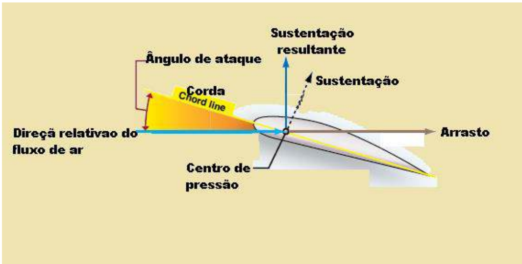
Figura 13-4 Ângulo de ataque positivo.
