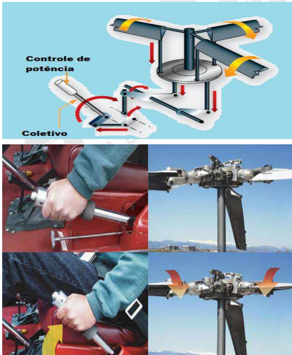
Fonte: FAA - Mechanic Training Handbook-Airframe Figura 13-45 Mecanismo de controle do passo coletivo.
