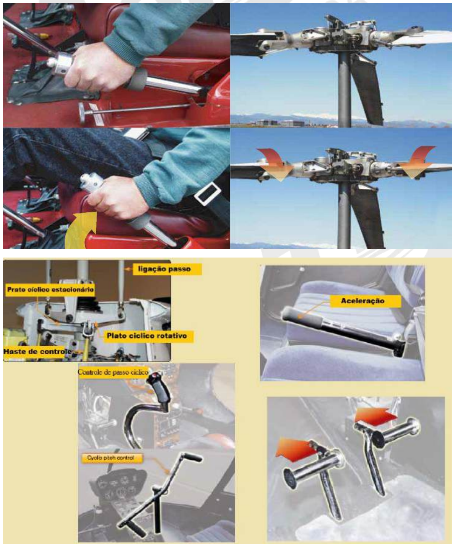
Figura 13-46 Sistema de controle de helicóptero convencional.
