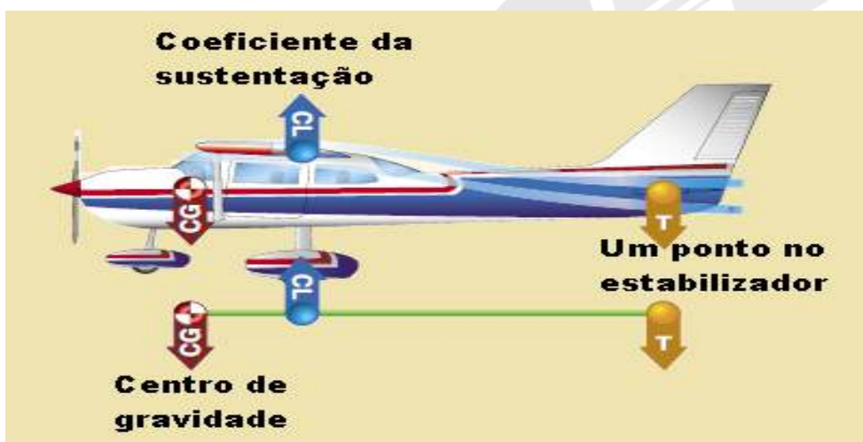
Fonte: FAA - Mechanic Training Handbook-Airframe Figura 13-12 Sustentação na empenagem.
