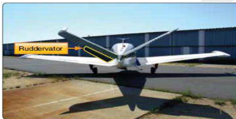
Figura 13-26 Ação dos Ruddervators
