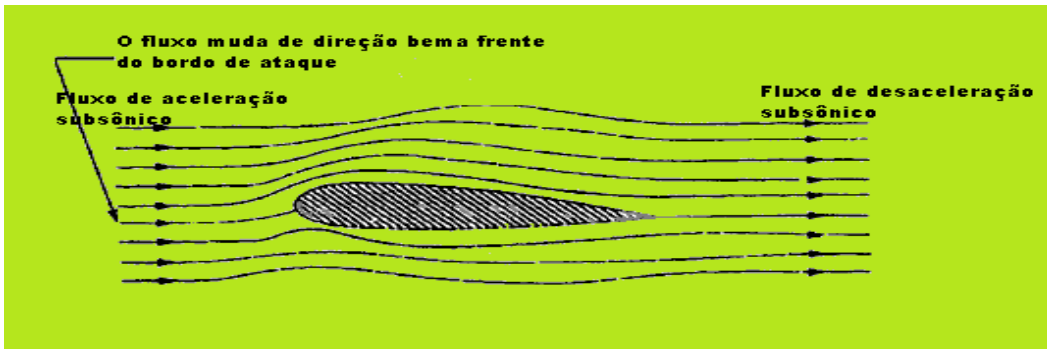
Figura 13-47 Exemplo típico de fluxo subsonico, asa subsonica.
