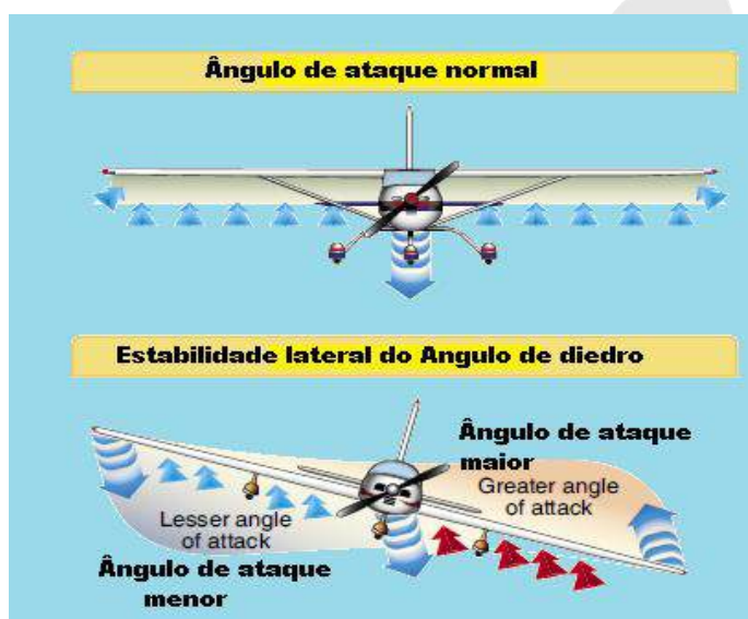
Figura 13-14 Contribuição do diedro para a estabilidade lateral.
