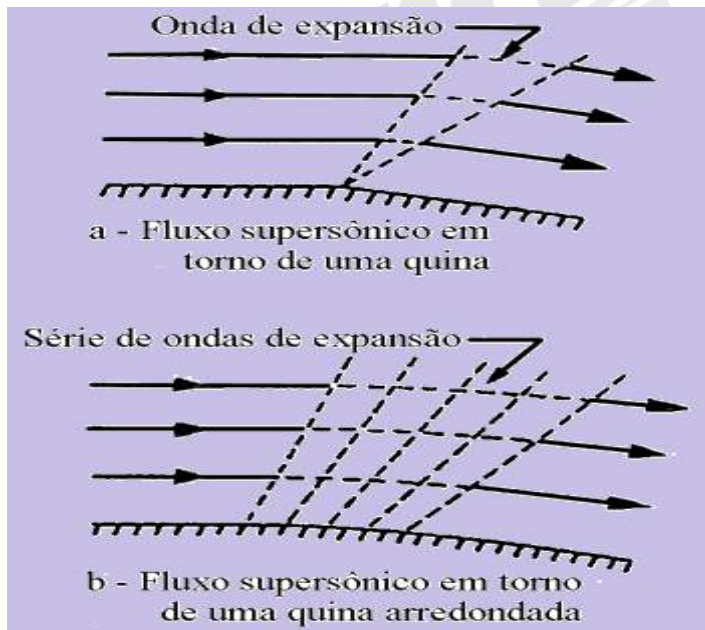
Figura 13-53 Formação de onda de expansão.
