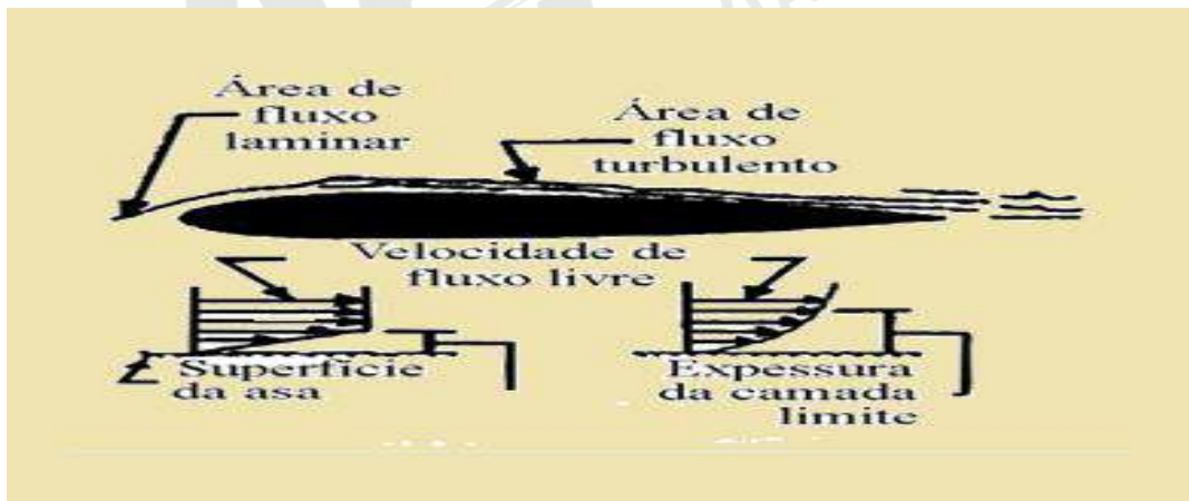
Figura 13-31 Características da camada limite.
