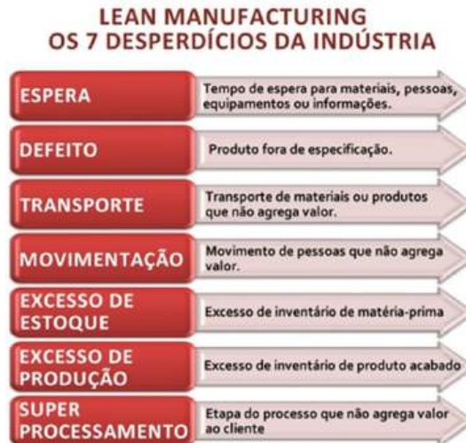
Figura 1: Os sete principais tipos de desperdícios encontrados nas empresas. Fonte: Womack e Jones (1998).
