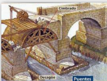
Esquema constructivo de un puente, un acueducto y una calzada romana
