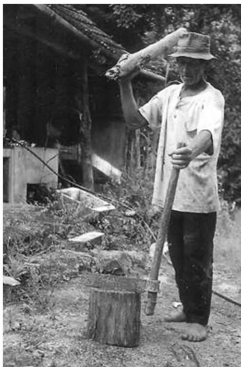
Lâmina usada para cortar “tabuinhas” de madeira para cobrir as casas
