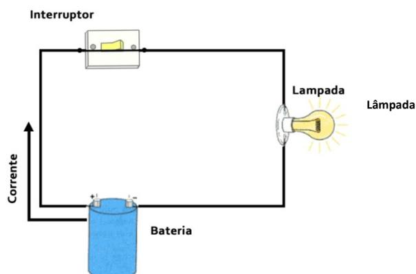
Ele representa um circuito elétrico, onde o interruptor está ligado, isso permite que a corrente elétrica circule da bateria até a lâmpada, fazendo com que ela se acenda.
