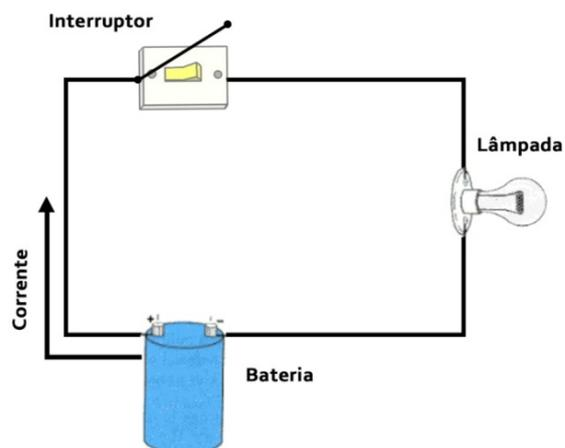
Ele representa um circuito elétrico, onde o interruptor está desligado, isso faz com que a corrente elétrica não circule da bateria até a lâmpada, ou seja, a lâmpada não acenderá.
