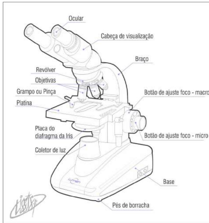
Figura 4. Diagrama de um microscópio óptico. Retirado de Blog MCientífica,2019.
