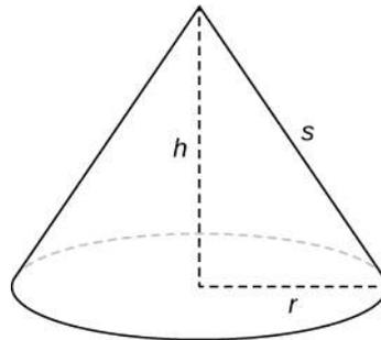
**Figura 6.43** El área superficial lateral del cono viene dada por  $\pi r s$ .
