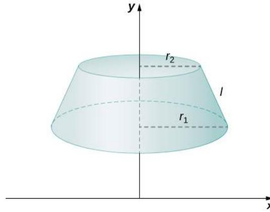
**Figura 6.42** El tronco de un cono puede aproximarse a una pequeña parte del área superficial.
