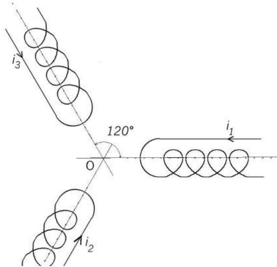
La rotation de l'aimant central à la vitesse angulaire  $\omega$  produit dans ces trois bobinages des f.é.m. induites qui forment un système triphasé équilibré (à condition que le circuit magnétique et la forme des bobinages soient tels que les f.é.m. induites soient sinusoïdales).
