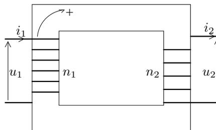
Sur chaque bobinage,  $i$  est tel que  $i$  positif entraîne un champ magnétique positif (d'où les sens de  $i_1$  et  $i_2$  sur l'exemple ci-dessus).
