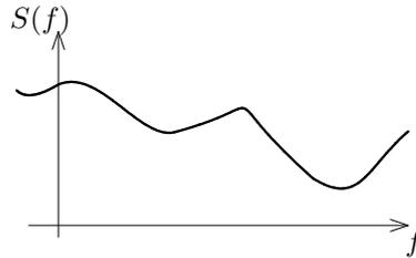
On peut considérer qu'il s'agit de la juxtaposition d'un nombre infini d'impulsions de Dirac. On appelle *support fréquentiel* d'un signal l'intervalle de fréquences entre lesquelles son spectre présente de l'énergie.
