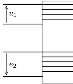
Un transformateur statique se composera donc d'un circuit magnétique sur lequel sont bobinés deux enroulements distincts.
