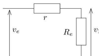
Déterminons  $R_e$  de manière à réduire les pertes par effet Joule dans le générateur. Ces pertes valent :
