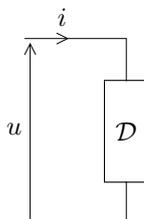
On définit la *puissance instantanée* dissipée dans le dipôle par
