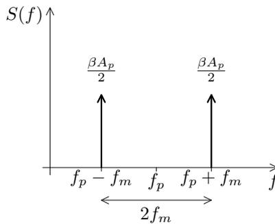
Bien qu'encore virtuellement présente, la porteuse est cette fois-ci plus difficile à détecter. Cependant, l'énergie nécessaire pour transporter le signal est moindre que dans le cas de la modulation à porteuse conservée.
