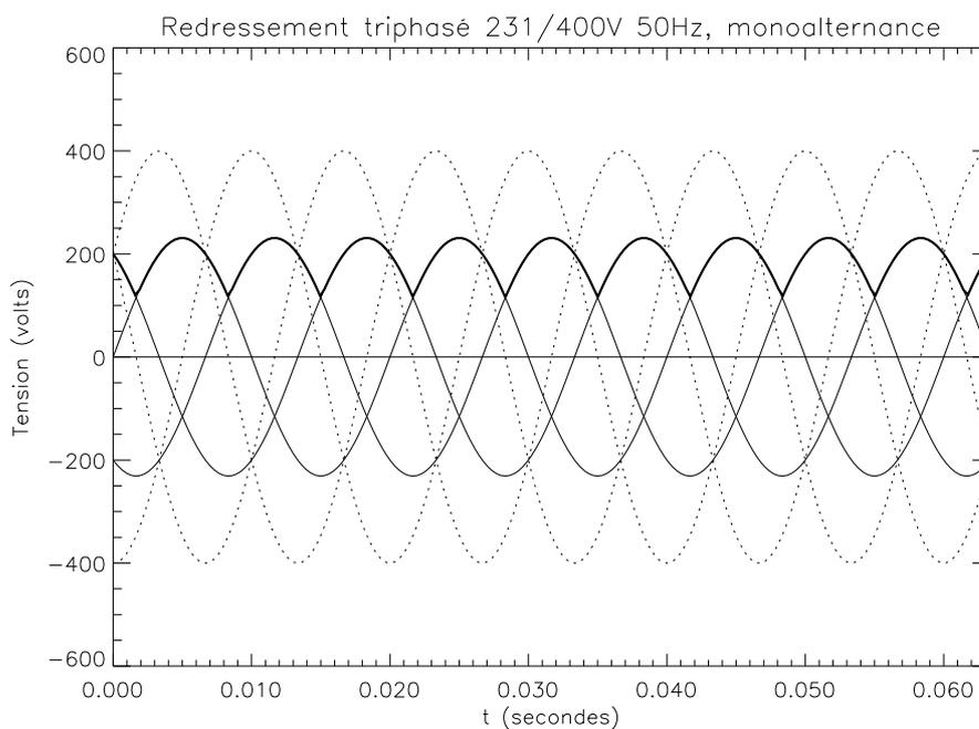
On montre que la valeur moyenne de la tension sur la charge vaut dans le cas général d'un système à  $q$  phases :
