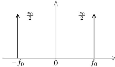
Cette représentation est la représentation *fréquentielle* du signal, et la fonction  $X(f)$  correspondante, ici limitée à deux pics à  $\pm f_0$ , est sa « transformée de Fourier ». Le *module* de  $X(f)$ , noté  $S_x(f) = |X(f)|$ , est le *spectre* du signal.
