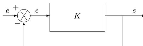
On rappelle que l'opérateur à l'entrée du système est un « soustracteur » et réalise l'opération  $e - s$ . On a alors les relations suivantes :
