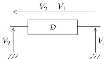
Dans le bas de ce schéma, les symboles rayés indiquent la *référence de potentiel nulle*, appelée la *masse*, par rapport à laquelle sont définis les potentiels  $V_1$  et  $V_2$ .
