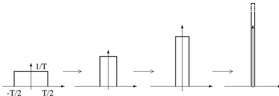
FIG. 1.4 – Construction d'une impulsion de Dirac
