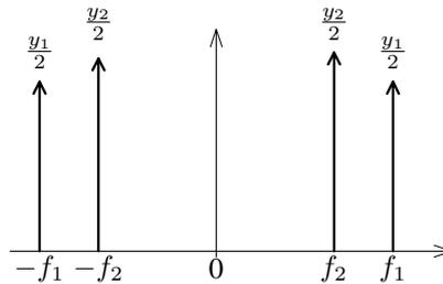
Un problème (qui n'en est bien sûr pas un...) semble se poser pour un signal de la forme  $z(t) = z_1 \cos \omega_1 t + z_2 \sin \omega_2 t$ . Revenons à la décomposition que nous avons déjà utilisée :
