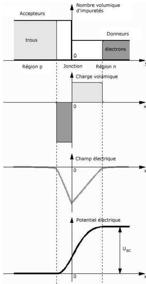
**Exemple :** pour une jonction pn au silicium avec un dopage  $N_A = 10^{18} \text{ cm}^{-3}$  dans la région p et un dopage  $N_D = 10^{17} \text{ cm}^{-3}$  dans la région n, la hauteur de la barrière de potentiel à 300 K (27°C) à l'équilibre vaut 872mV.
