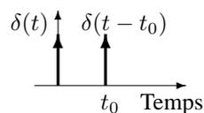
FIG. 1.5 – Représentation schématique d'une impulsion de Dirac
