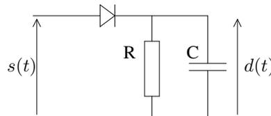
On doit calculer les valeurs de la capacité et de la résistance pour que la décroissance de la tension de sortie entre deux maxima locaux permette d'« accrocher » la partie ascendante suivante de la sinusoïde du modulant :
