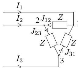
Les tensions de ligne et de phase sont identiques :  $U = V$ . Par contre  $I$  et  $J$  sont différents. La loi des nœuds appliquée au point 1 conduit à  $I_1 = J_{12} - J_{31}$ . Si le système des courants est direct, alors  $J_{31} = a J_{12}$  d'où  $I_1 = J_{12}(1 - a)$ . Le même type de calculs que celui du paragraphe précédent permet d'établir la relation  $I_1 = J_{12}\sqrt{3}e^{-j \frac{\pi}{6}}$ .
