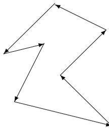
Cependant, ce mouvement, à une vitesse non nulle, ne se traduit pas par un déplacement global susceptible de se traduire en courant électrique. Pour mettre en mouvement ces charges dans une direction donnée, il est nécessaire d'appliquer un *champ électrique* aux bornes du conducteur. En appliquant le potentiel électrique  $V_1$  et le potentiel  $V_2$  à ces deux bornes, on crée une *différence de potentiel* qui met les électrons<sup>2.4</sup> en mouvement<sup>2.5</sup>.
