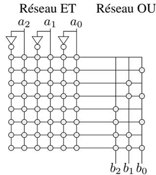
Dans le schéma d'un PAL à 3 bits ci-dessus, les cercles indiquent des fusibles, *ie* des points où les connexions peuvent être établies ou non. La programmation est réalisée en appliquant des différences de potentiel capables de « claquer » ces fusibles, et la déprogrammation en exposant le réseau à des ultraviolets qui les « régénèrent ».
