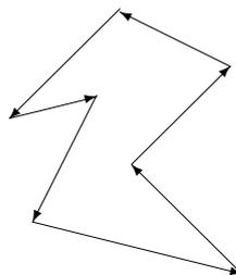
FIG. 4.2 – Déplacement d'un électron : l'électron revient *en moyenne* à son point de départ, donc sa vitesse moyenne est nulle ; mais il se déplace, donc en moyenne, sa vitesse n'est pas nulle : on estime cette dernière valeur par la vitesse quadratique moyenne.
