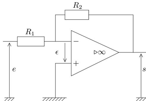
On a  $\epsilon = 0$ , et  $i_+ = i_- = 0$  A. En appliquant le théorème de Millman (cf. Annexe B, paragraphe B.2), comme  $V_+ = V_- = 0$  V, il vient :
