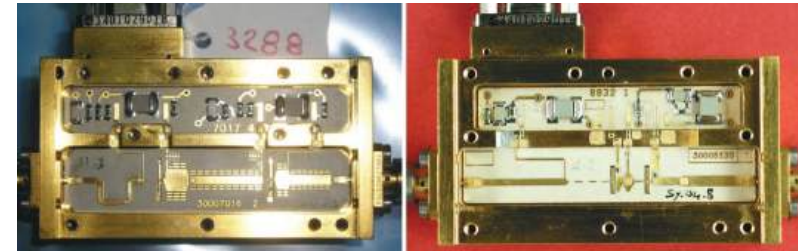
Figura 9: Amplificadores criogénicos de bajo ruido y banda ancha construidos por el OAN/CNIG para el instrumento HIFI. El de la izquierda corresponde al diseño realizado para los receptores 1 a 5 y el de la derecha para los receptores 6 y 7.
