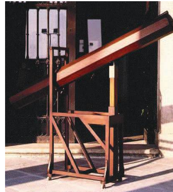
Figura 5: Telescopio de 7 pies de longitud construido por W. Herschel para el Observatorio Astronómico de Madrid. Es similar a aquel con el que descubrió Urano.
