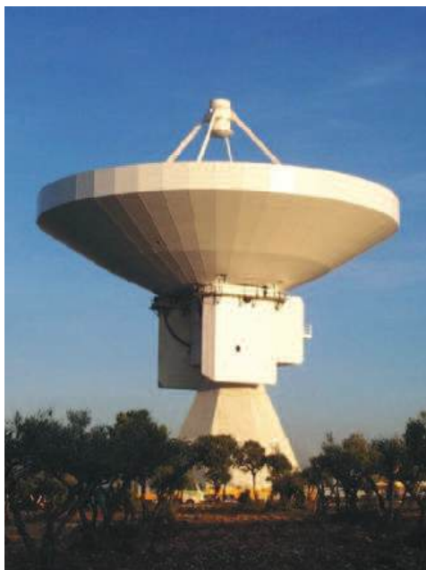
Figura 9: Radiotelescopio de 40 metros de diámetro. Centro de Desarrollos Tecnológicos y Observatorio Astronómico Nacional. Instituto Geográfico Nacional, Yebes (Guadalajara).
