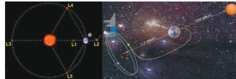
Figura 10: Puntos de Lagrange del sistema Sol-Tierra. Herschel orbitará alrededor del punto L2, tal como se indica en el esquema de la derecha.
