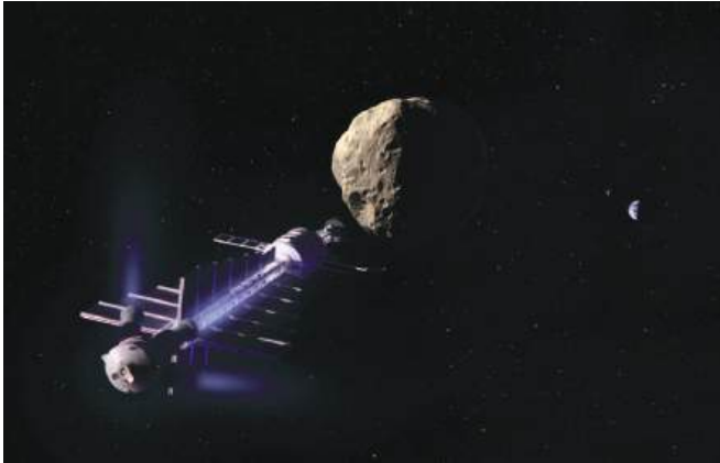
Figura 14: Tractor gravitatorio para arrastrar un asteroide fuera de su órbita. Se trataría de una nave espacial de 20 toneladas alimentada con un reactor nuclear. Emplearía motores iónicos para moverse y arrastrar el asteroide de modo continuo. Imagen de Dan Durda (FIAAA, Fundación B612).
