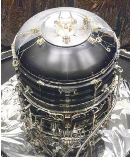
Figura 4: Criostato instalado en un banco de pruebas.
