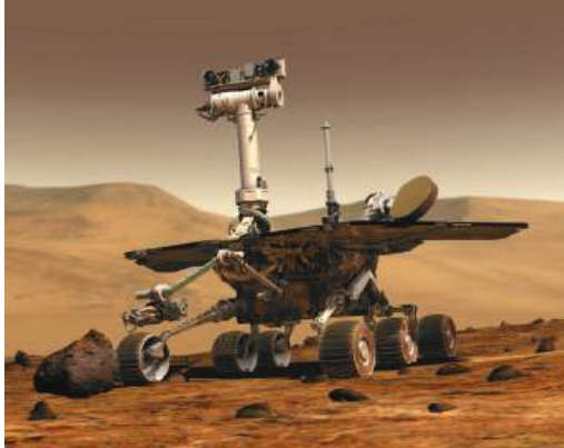
Figura 7: Impresión artística de uno de los dos robots transportados por la misión Mars Exploration Rover (MER) para la exploración “in-situ” de la superficie de Marte (cortesía de NASA).
