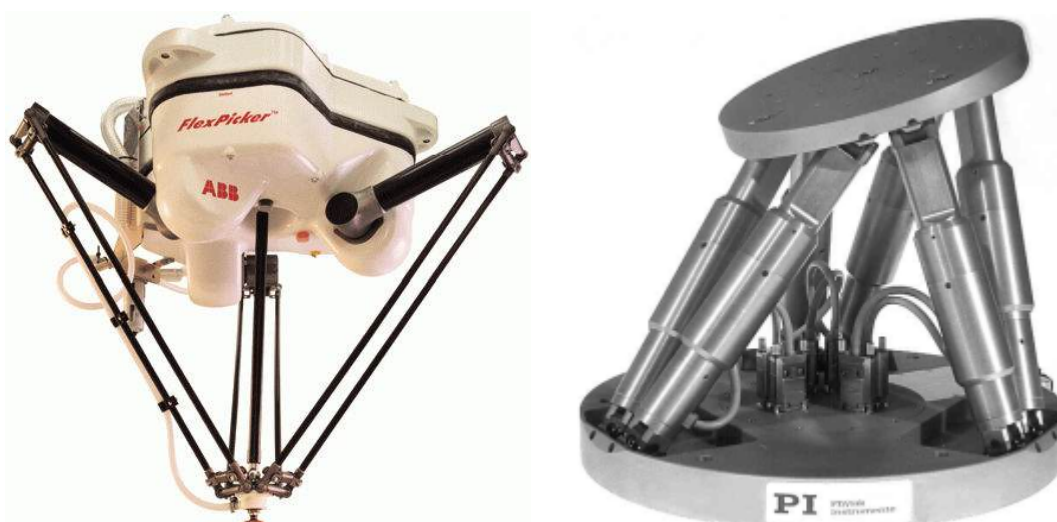
Fig. 2.21 – O manipulador paralelo Delta, de cadeia fechada, produzido pela ABB (esquerda), e o Hexapod (também paralelo) produzido pela PI (à direita), com juntas prismáticas.
