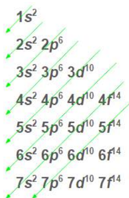
Figura 3.5. Esquema de llenado de los orbitales con electrones en la configuración electrónica.
