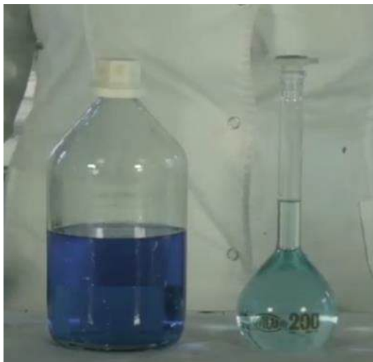
Figura 7.1. Soluciones de \text{Cu}_2\text{SO}_4 , stock (izquierda) y diluida (derecha). Extracto del video-capítulo del Manual Digital de Laboratorio CEAEQ, publicado en https://www.youtube.com/watch?v=jVv4RZQ97Iq&t=12s
