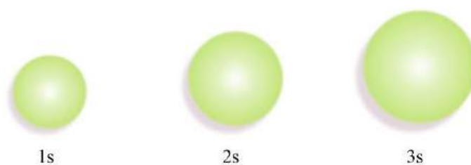
Figura. 3.2. Los orbitales atómicos s de los niveles 1, 2 y 3 comparten una misma geometría, pero difieren en su tamaño y, en consecuencia, en su energía asociada.
