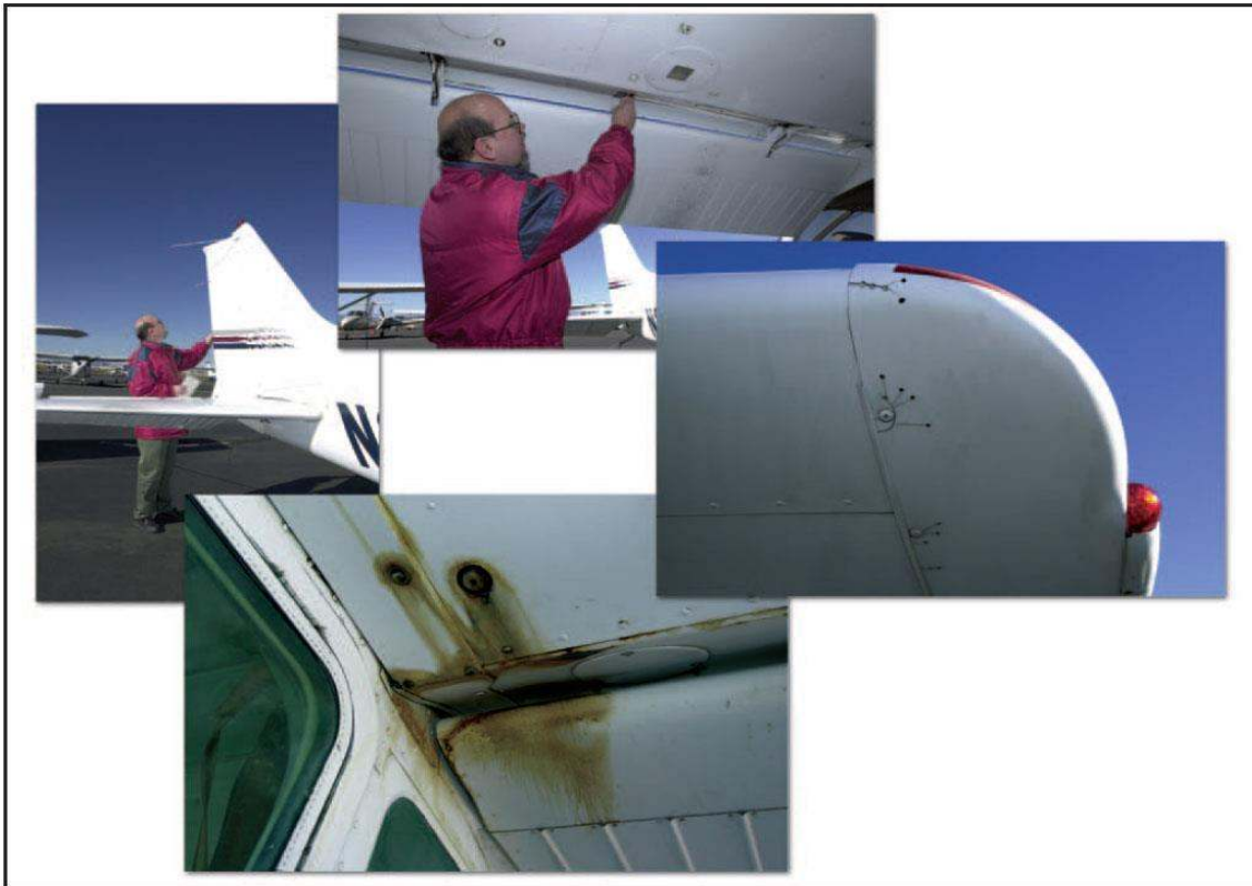
Figura 2-9. Inspección del ala y sección de cola.
