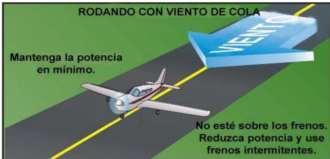
Figura 2-16. Rodaje con viento de cola.
