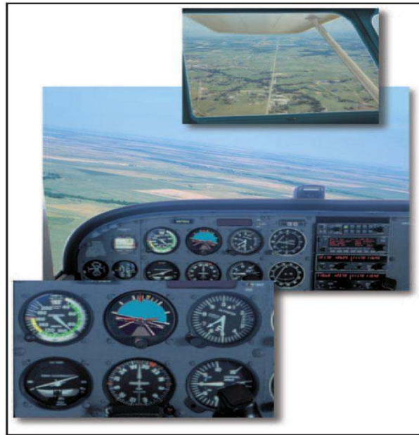
Figura 3-5. Viraje nivelado a izquierda.
