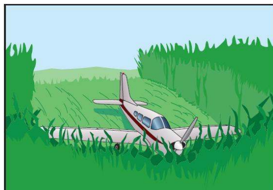
Figura 14-1. Uso de la vegetación para absorber energía.
