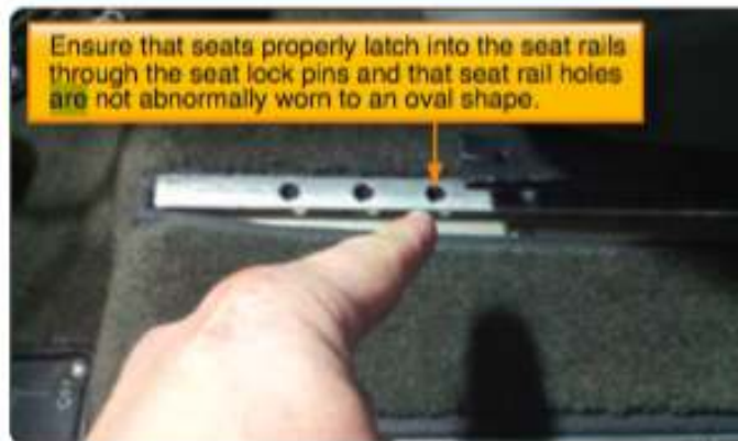
Figura 2-4. Se deben inspeccionar los asientos para asegurarse de que estén correctamente enganchados en los rieles del asiento y se verifique que no estén dañados.
