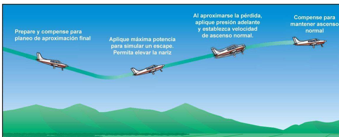
Figura 4-8. Pérdida por compensador de timón de profundidad.
