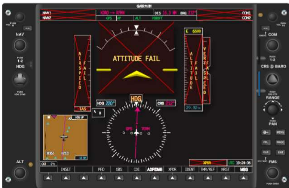
Figura 2-8. Las inspecciones en tierra incluyen la verificación de que se muestran "X" en la pantalla del instrumento hasta que se activa el sensor.
