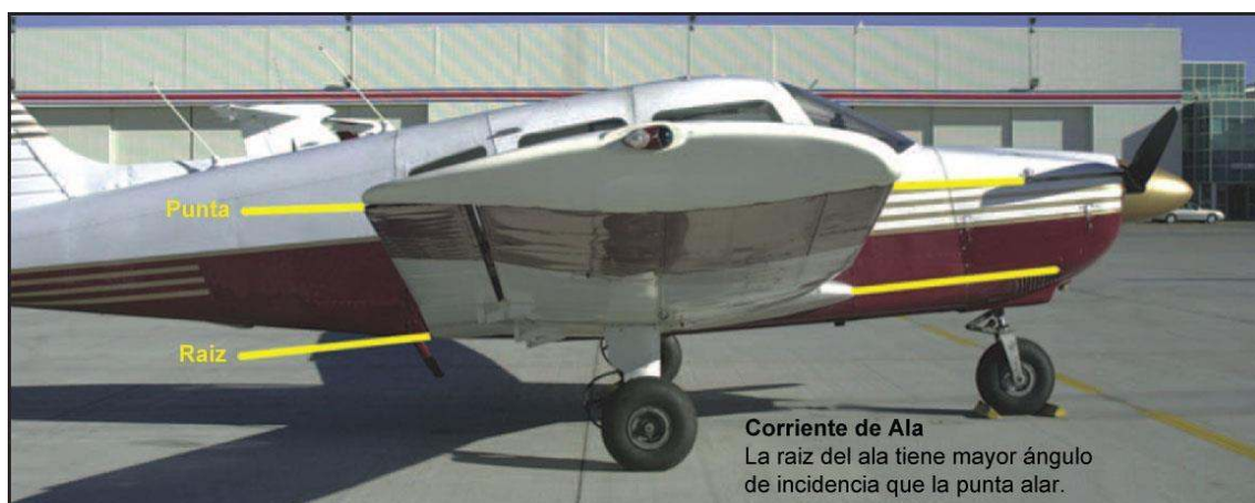
Figura 4-4. Corriente o flujo en la punta alar.
