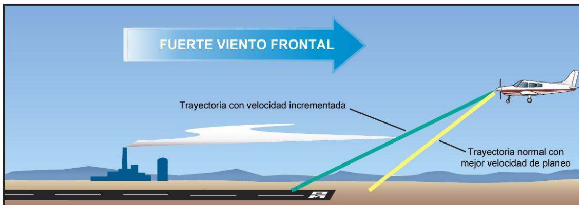
Figura 8-2. Efecto del viento frontal sobre la aproximación final.
