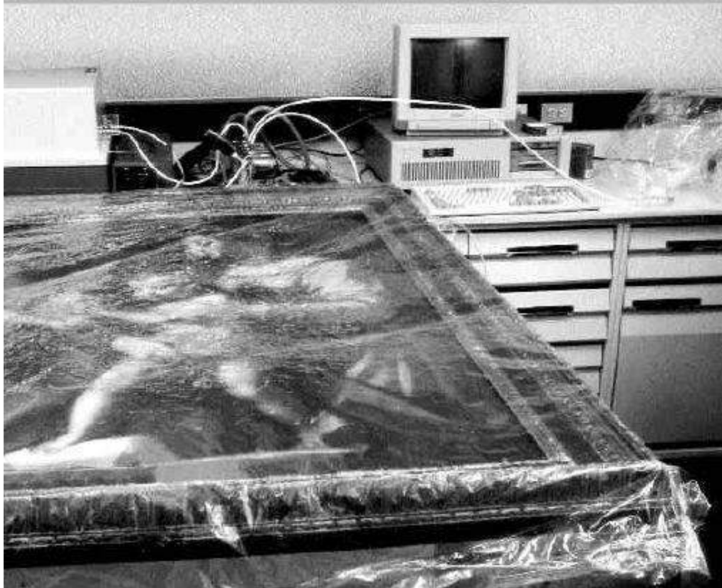
Fig. 2 Anoxic plastic enclosure (same ref; fig. 6)
