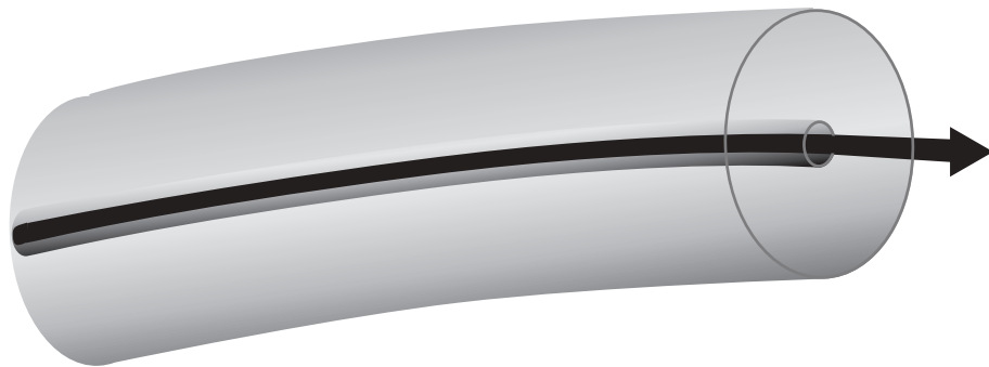
Figura 4.8: Transmissão num cabo de fibra monomodo
