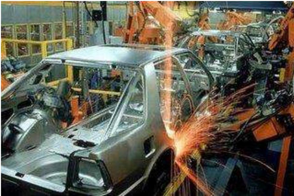
Figura 106. Uso industrial de la soldadura por puntos.
