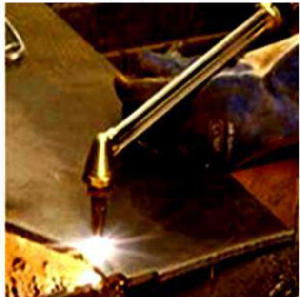
Figura 97. Corte manual en el oxiacetileno.
