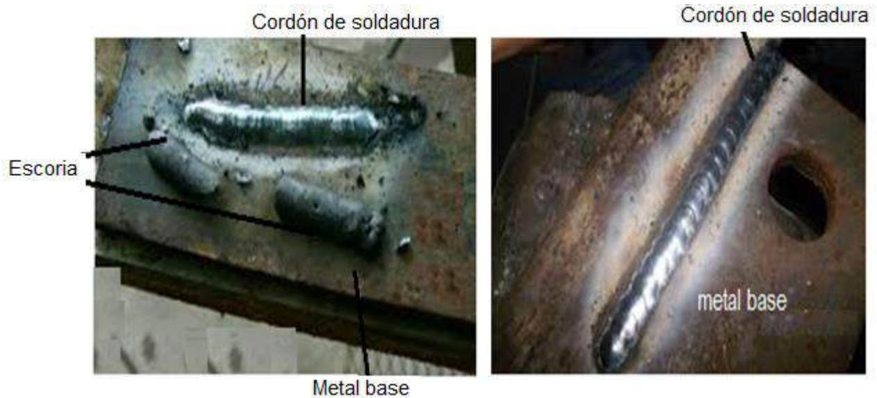
Figura 8. Cordón de soldadura por arco eléctrico.
