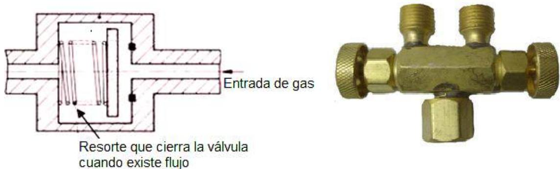
Figura 84. Válvula antirretroceso.
