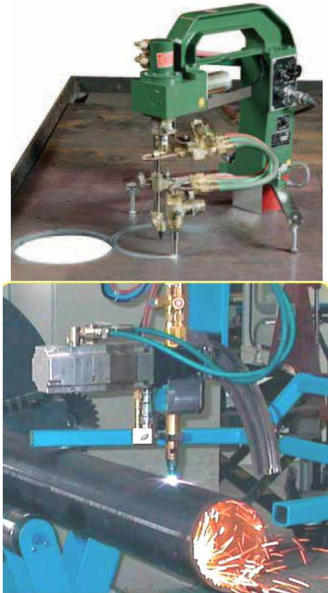
Figura 100. Corte circular con equipo automático
