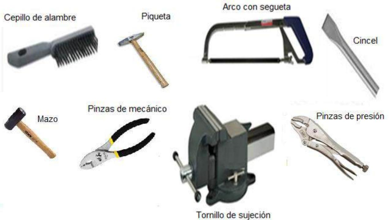
Figura 32. Accesorios para la soldadura por arco eléctrico.
