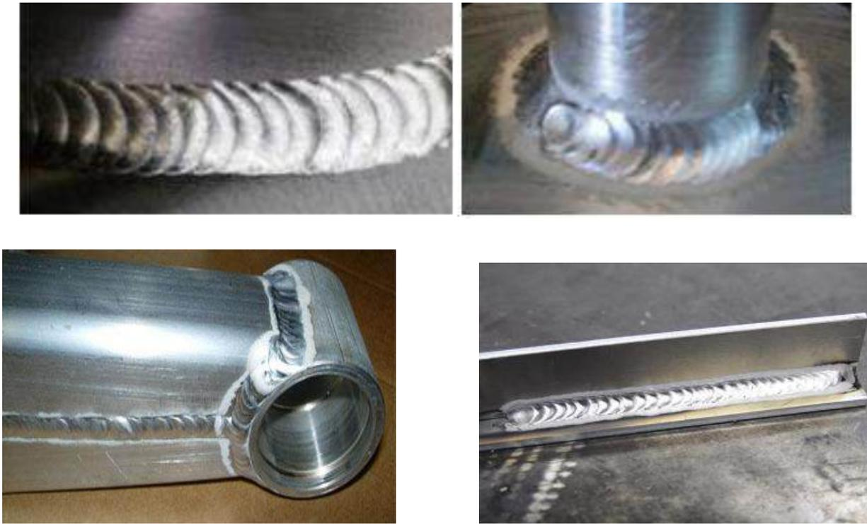
Figura 134. Soldadura de aluminio en el proceso G.T.A.W.
