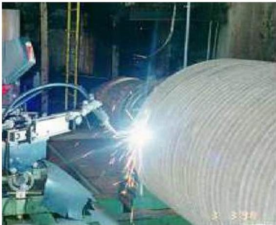
Figura 158. Reparación de un eje.
