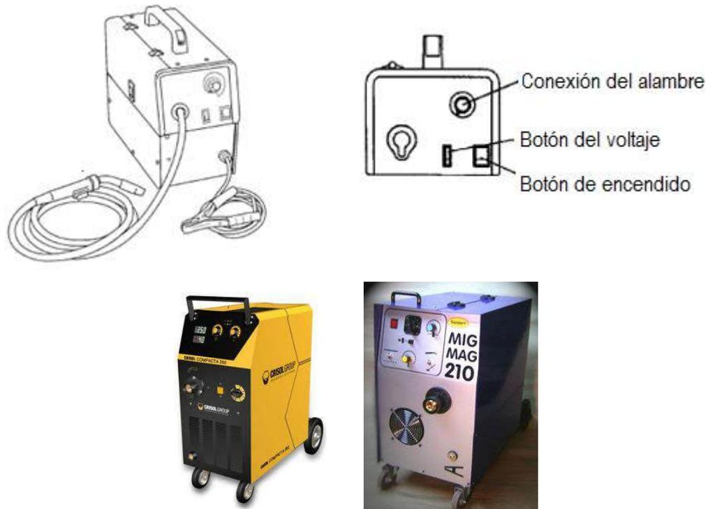
Figura 145. Máquina de soldar para el proceso G.M.A.W.
