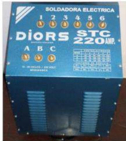
Transformador con conexiones
