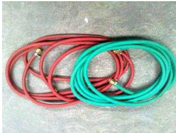
Figura 83. Mangueras para el oxígeno y acetileno.
