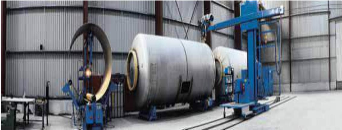
Figura 151. Soldadura G.M.A.W. en un recipiente para gas.
