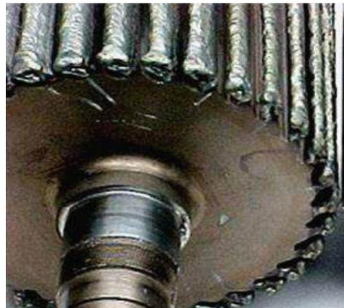
Figura 156. Reparación de dientes de engranaje.
