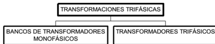
Figura 31: Clasificación de transformaciones trifásicas según el tipo de transformador
